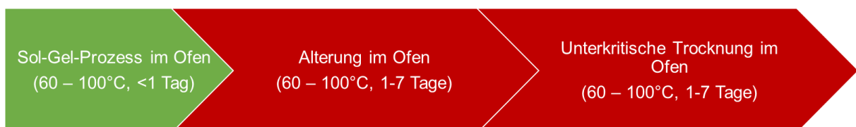
Abbildung 1: Schematische Darstellung der einzelnen Schritte der Aerogelsynthese. Rot gekennzeichnet sind die energieintensiven Schritte der Alterung und Trocknung.
