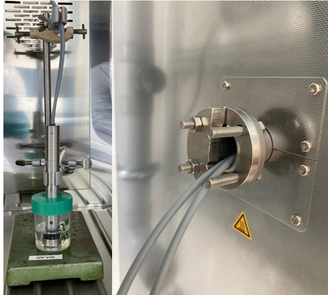
Abbildung 4: UV/Vis-Aufbau im Wärmeschrank (links) und Anschluss des optischen UV/Vis-Sensors an den Wärmeschrank (rechts).
