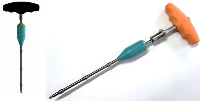
Abbildung 4: Zeichnung und Prototyp des Drehmomentinstruments aus Arbeitsende, bestehend aus Welle mit Messaufsatz, und über eine Kupplung verbundenen T-Griff.
