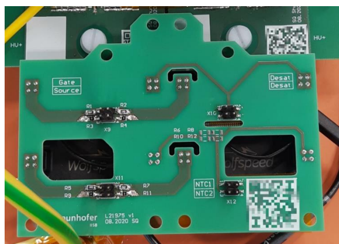
Abbildung 20: Prototyp einer Adapterplatine für die Parallelschaltung zweier Leistungsmodule
