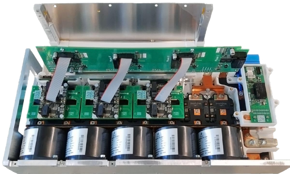
Abbildung 28: Ansicht des aufgebauten MTAB-Stromrichters im Test-Modus
