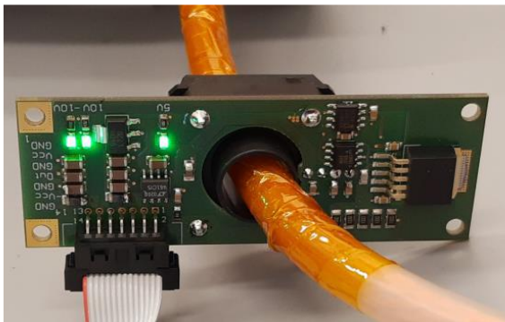
Abbildung 22: Messung mit dem Prototypen eines Stromsensors
