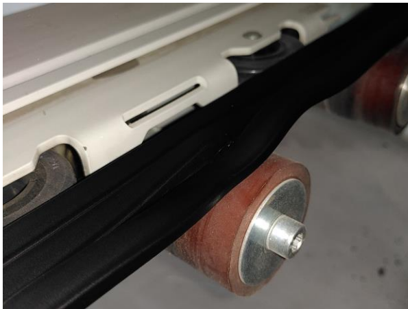
Abbildung 46: Ausweichen des mehrlagigen TPS in eine wellige Form während der Applikation.
