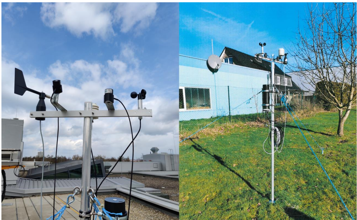
Abbildung 67: Verwendete Wetterstation für die Analyse der Solaranlagen in Marktschorgast. Diese ist ausgestattet mit Temperatur- und Feuchtesensor, Windrichtungs- und Windgeschwindigkeitsgeber sowie zwei Pyranometern (Horizontal und in der Kollektorebene).
