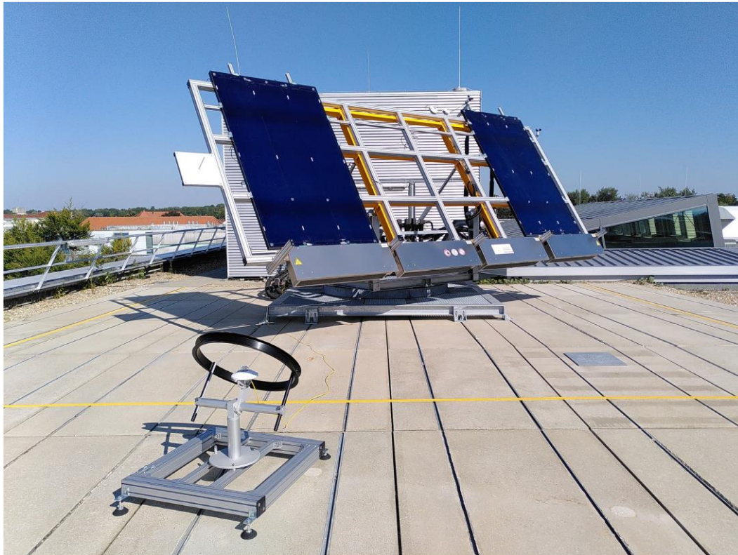
Abbildung 52: Prüfaufbau der Leistungsmessungen am Solar-Tracker der THI. Zwei Prototypen konnten zeitgleich geprüft werden und die Kollektorkenndaten nach ISO 9806 ermittelt werden. Zusätzlich erlaubte der Prüfaufbau die Bestimmung des Winkelkorrekturfaktors IAM.
