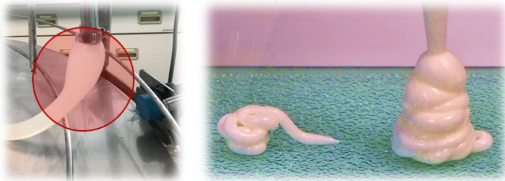
Abbildung 6-19: Ausdehnung und erheblicher Nachlauf
