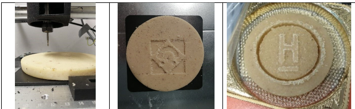
Abbildung 6-51: Beispiele für das direkte Fräsen von Marzipanmasse
