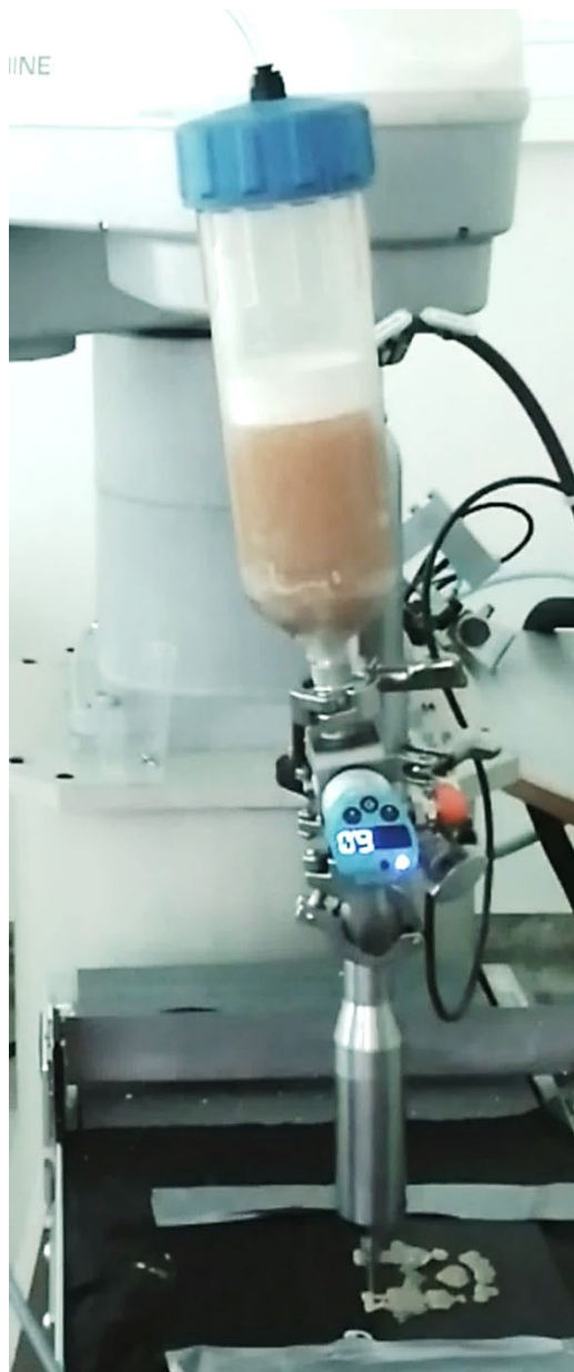
Abbildung 6-42: 3D Druck von Tortenauflegern.
