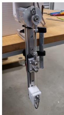
Abbildung 16: Lebensdauerprüfstand zum Zyklieren den FGL-Drähten bei verschiedenen Frequenzen und Dehnungen.
