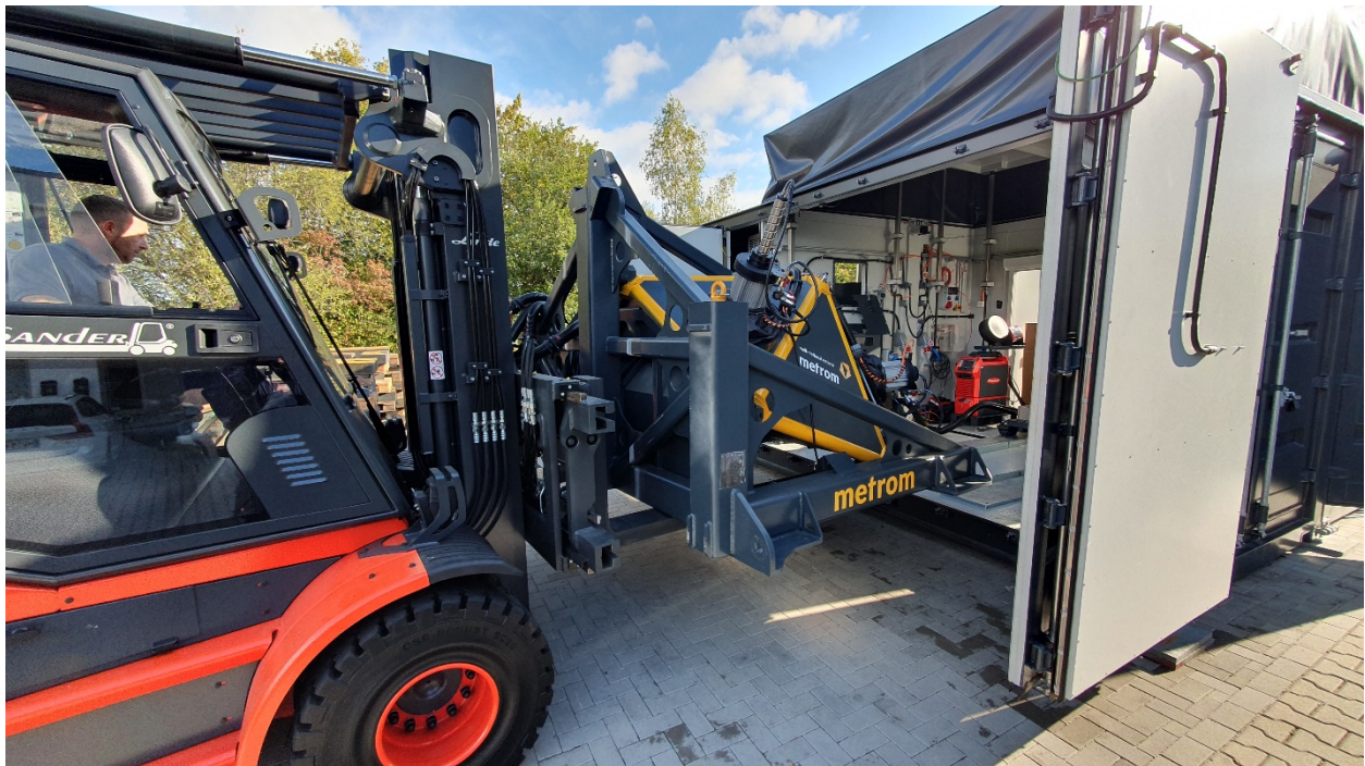
Abbildung 2: Einbau der PM800 nach Gestellkipfung
