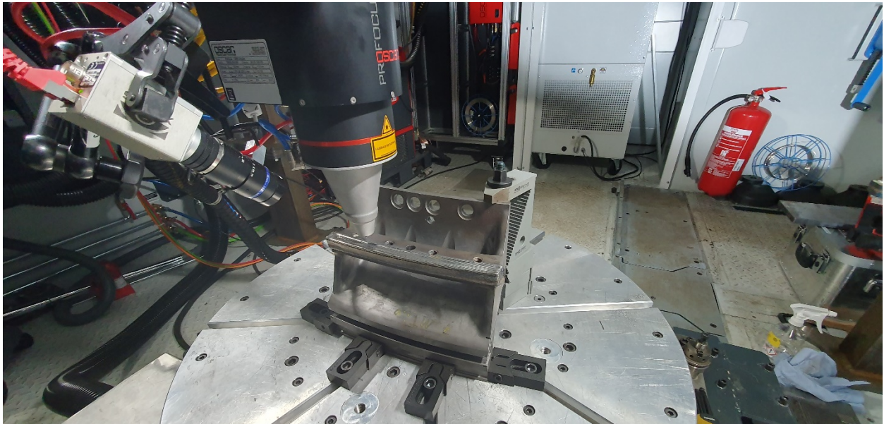
Abbildung 4: Mittels LMD instandgesetztes Turbinenbauteil
