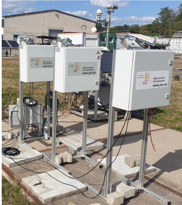
Abbildung 6: 3 AVUSpro-Prototypen am Soilingteststand auf dem Außentestfelds Fraunhofer ISE in Freiburg
