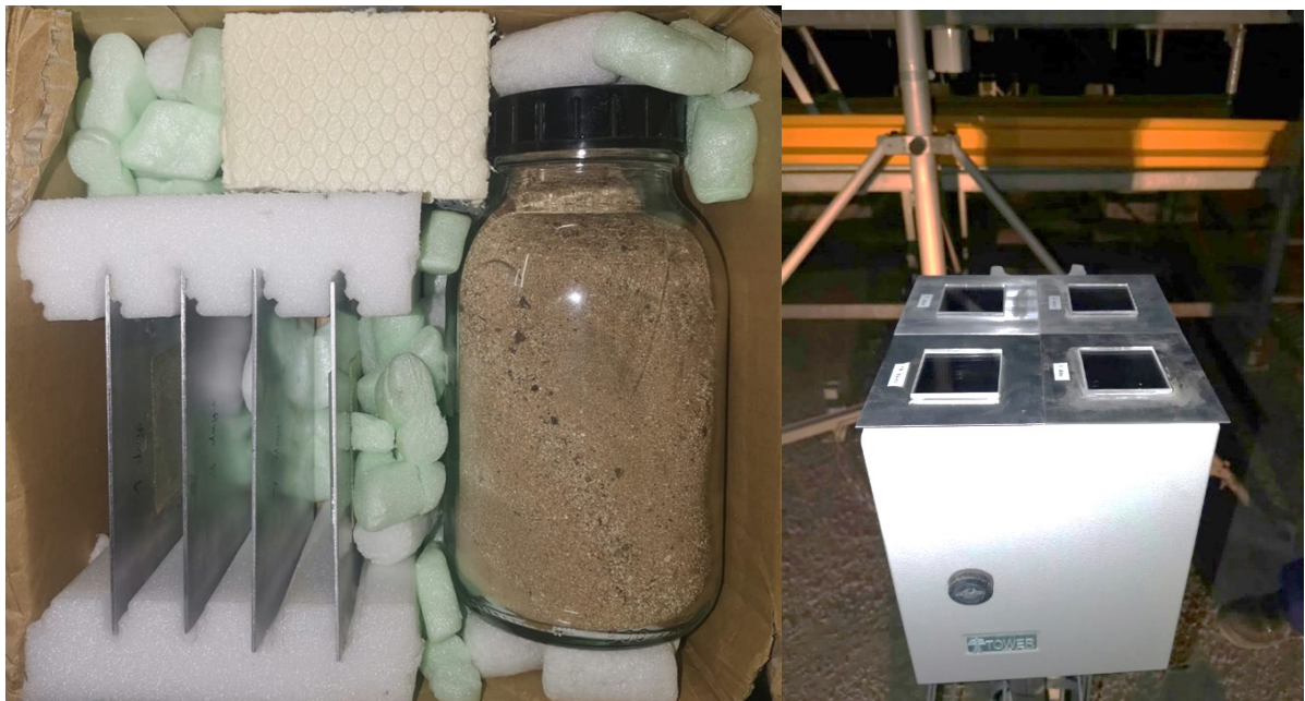
Abbildung 31: Box mit Behälter für feinen Staub für spätere künstliche Verschmutzung im Labor und weiterführende Analysen (links) und Spiegelexposition auf dem Schaltschrank der Wetterstation in Shagaya (rechts)
