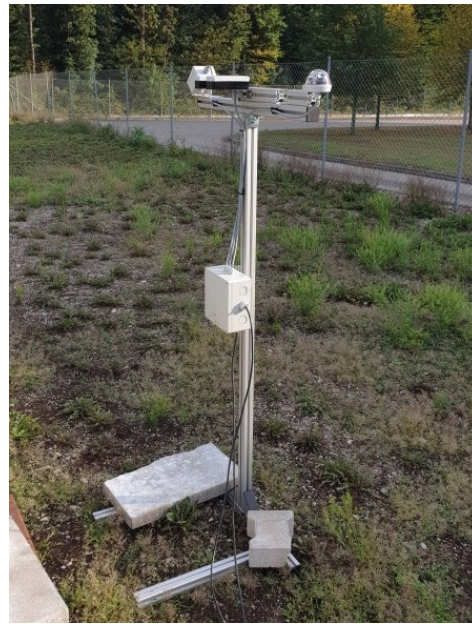
Abbildung 1: Links: Ausgewählte Sensoren mit Messprinzipien für die Vermessung auf dem ISE Testgelände. Rechts: Regenmelder mit Elektronik und Embedded PC auf dem Freigelände des Fraunhofer ISE
