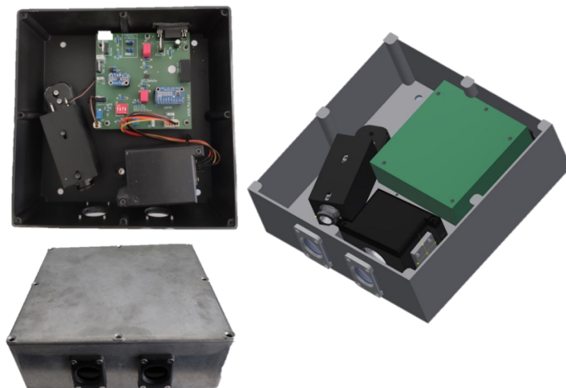
Abbildung 8: AVUSpro Measurement Unit, finales Design und Aufbau. Das finale CAD Design der AVUSpro Measurement Unit (rechts) und Bilder der fertigen Measurement Unit (links) mit Lichtquelle, Sensoreinheit und Platine in offenem und geschlossenem Zustand.
