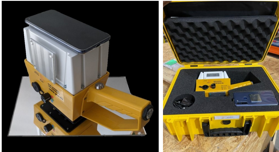
Abbildung 10: pFlex 2.0 auf einem Spiegel (links) und pFlex 2.0 mit neuem Transportkoffer entwickelt von der PSE Instruments GmbH (rechts)
