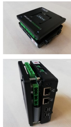
Abbildung 3: Überarbeitung des Steuermoduls des ersten AVUSpro Prototypen zur AVUSpro Steuereinheit Ein wichtiger Parameter, der noch untersucht wurde, ist der Stromverbrauch. Im Dauerbetrieb sollte weniger als 10 W/h verbraucht werden. Die Untersuchung wurde durchgeführt, nachdem Software und Mechanik fertig entwickelt waren. In der folgenden Abbildung ist der Stromverbrauch des Geräts über neuen Messzyklen dargestellt.
