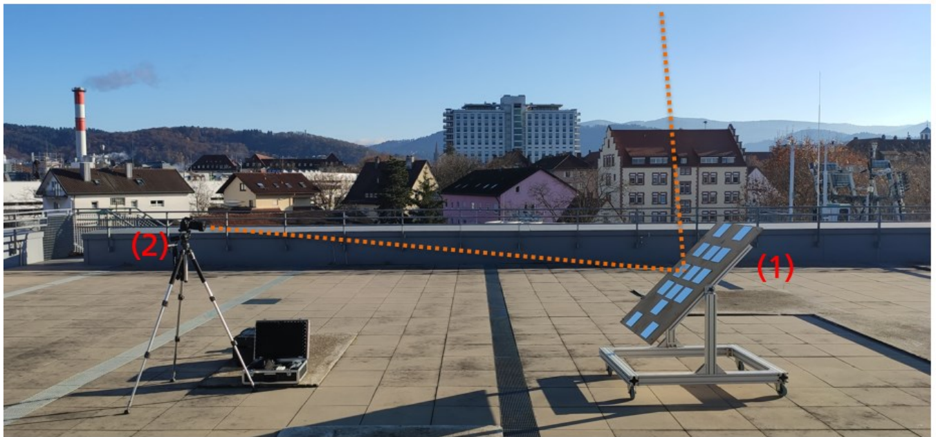
Abbildung 14: Kamerabasierte Soilingmessung auf dem ISE Dach R. Das Testboard (1) mit verschmutzten Spiegeln verschiedener Cleanliness Level wurde mittels einer speziell kalibrierten Leuchtdichtkamera (2) in verschiedenen Setups untersucht.
