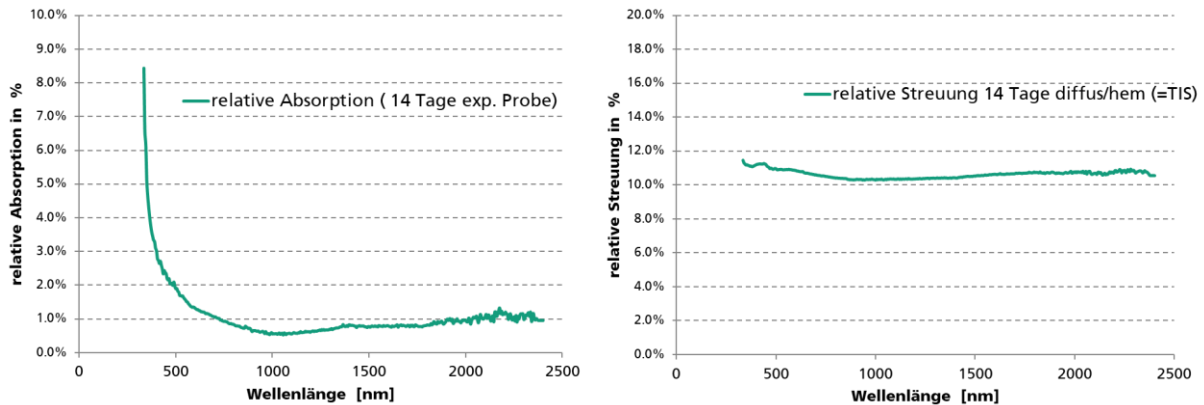
Abbildung 35: Analyse der spektrometrischen Messungen relative Absorption und Streuung der 14 Tage exponierten Probe
