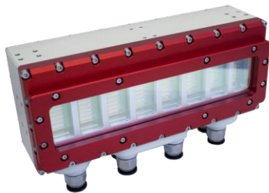
Abbildung 25: Direktiodenmodul mit 940 nm Wellenlänge
