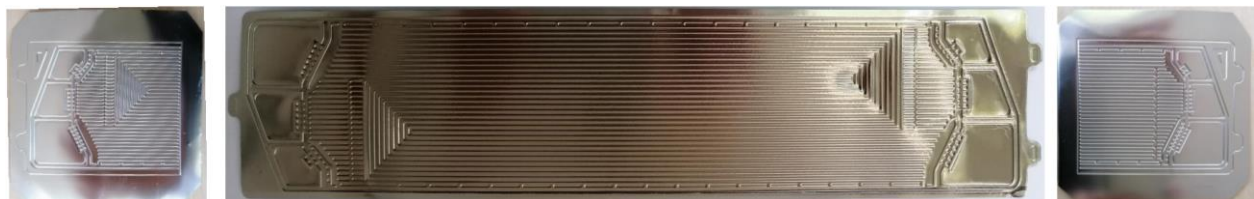
Abbildung 69: Muster der während des Projektes zu fertigenden BPP. Links: Manifoldbereich Kathode, mitte: Erster Prototyp der gewalzten BPP, rechts: Manifoldbereich Anode.
