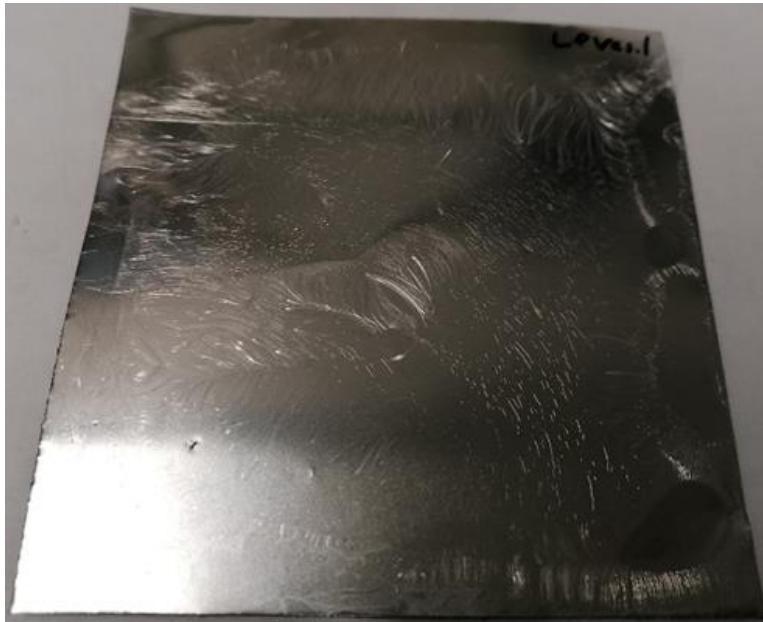
Abbildung 78: Behandlung eines beschichteten Bleches mit Nanopartikel-Lösung.
