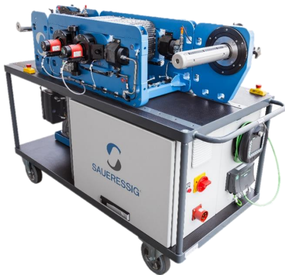
Abbildung 104: Saueressig Laborkalender. Die Konstruktion dieses Kalanders dient als Grundlage für die Konstruktion des R2R-Moduls
