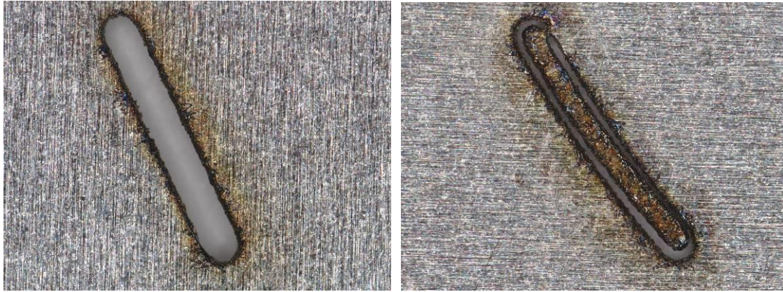
Abbildung 109: Schlitzöffnung vollständig geschnitten (links) und mit Steg am Schnittanfang/Ende, der das Herauslösen des Mittelteils verhindert.
