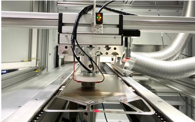
Abbildung 93: Messanordnung zur kontinuierlichen Messung des Kontaktwiderstandes der beschichteten Bauteile
