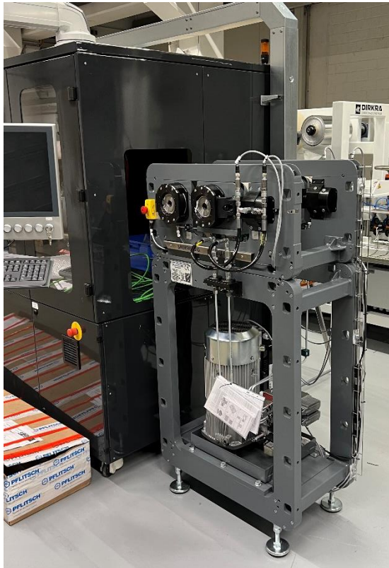
Abbildung 105: Foto des Kalandermoduls während der Integration in die R2R-Anlage
