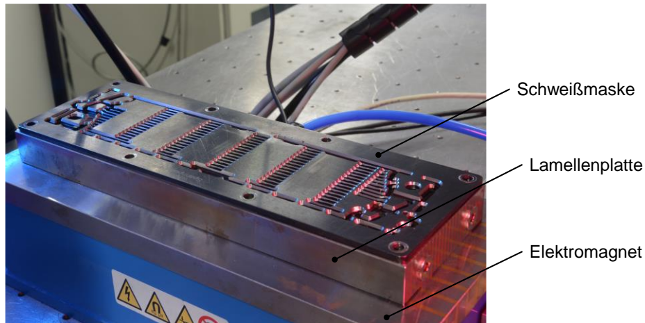
Abbildung 60: Aufbau der Spannvorrichtung für die Schweißversuche
