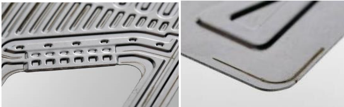
Abbildung 112: Schnittdetails; Links: Portöffnungen mit korrekter Positionierung Schweißnaht auf der linken Seite und Positionsfehler auf der rechten Seite. Rechts: Schnittkante und Schweißnahtsegment an der Außenkontur.
