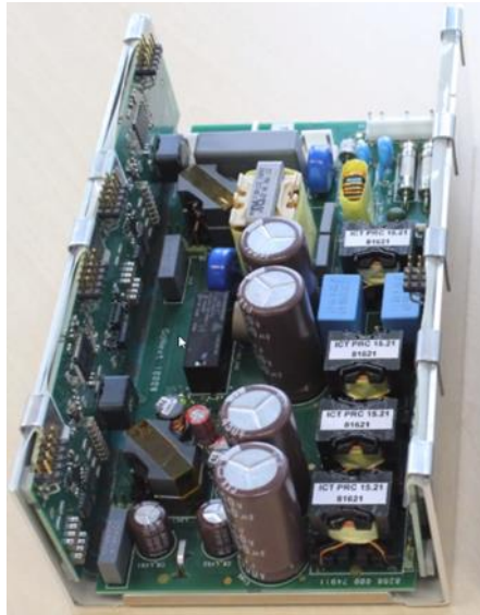
Abbildung 28: Signify 1kW LED Treiber
