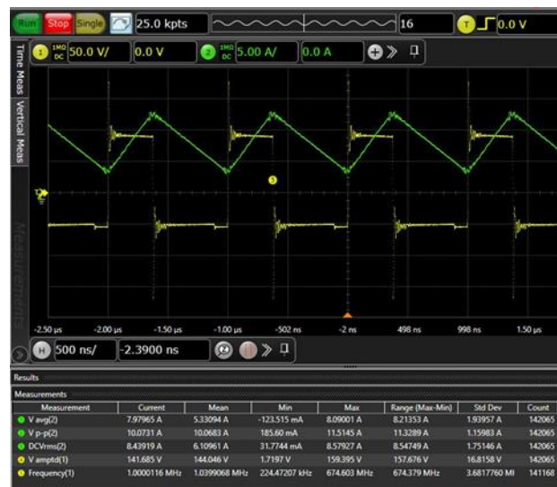
Abbildung 33: Buck-Inductor - 8 A DC + 10 A pp @ 1 MHz
