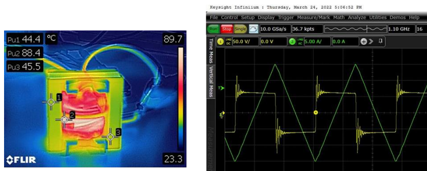
Abbildung 23: Full-Bridge Kurzschlussstest mit 9A Primärstrom @ 1 MHz
