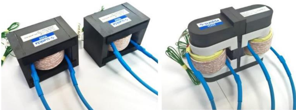
Abbildung 4: Zwei separate Drosseln (links, insgesamt 540 cm 3 ) und zwei magnetisch gekoppelte Induktivitäten (interleaved) (rechts, 397 cm 3 ) mit einer Volumeneinsparung von 27 %
