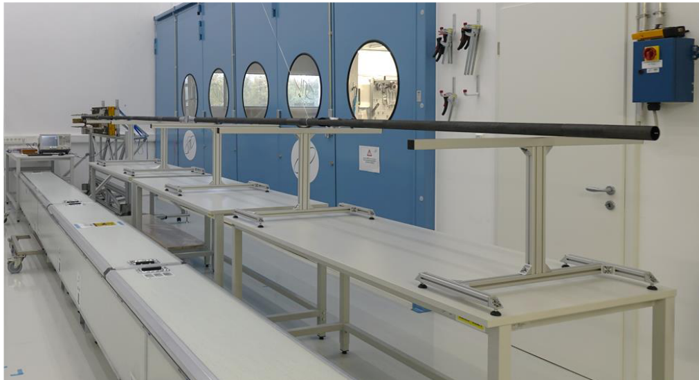
Abbildung 2.19: Reinraum bei STI mit EQM der Antenne auf Metallgestell gelagert.
