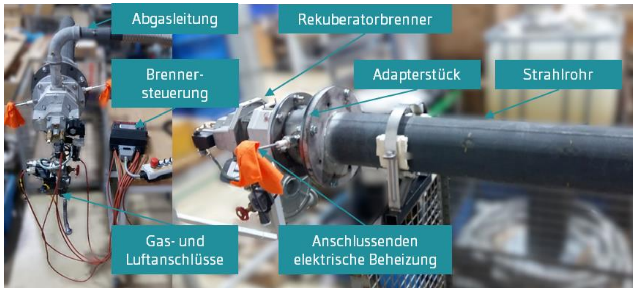
Abbildung 5: Hybrides Strahlrohr mit Rekuperatorbrenner und Steuerung am Prüfstand
