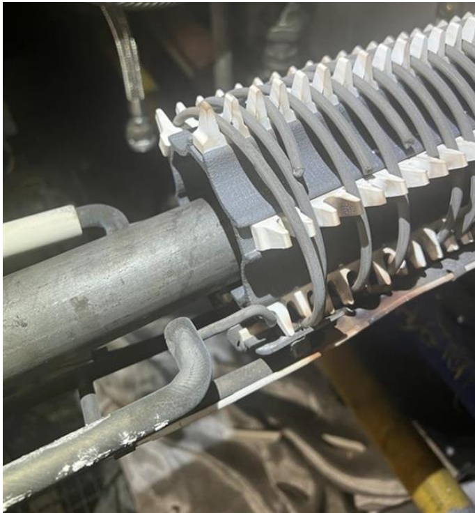
Abbildung 12: Defekt des Heizdrahtes
