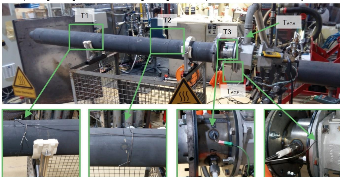
Abbildung 6: Hybrides Strahlheizrohr mit Temperaturmesstechnik
