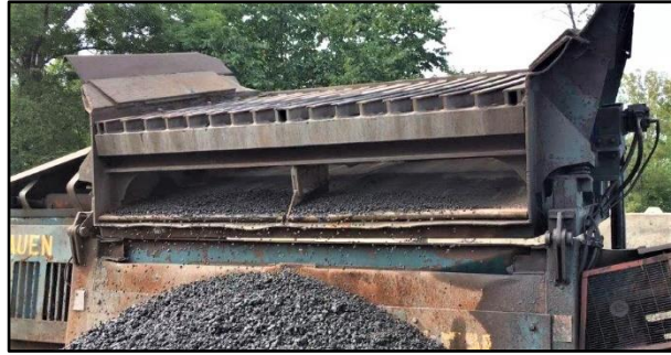
Abbildung 9: Absiebung der EOS von 0 – 45 mm auf eine Fraktion von 0 – 11 mm.
