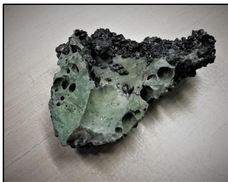
Abbildung 35: Schlacke des Umschmelzversuchs von Separationseisen zur Bestimmung des Metallgehalts.
