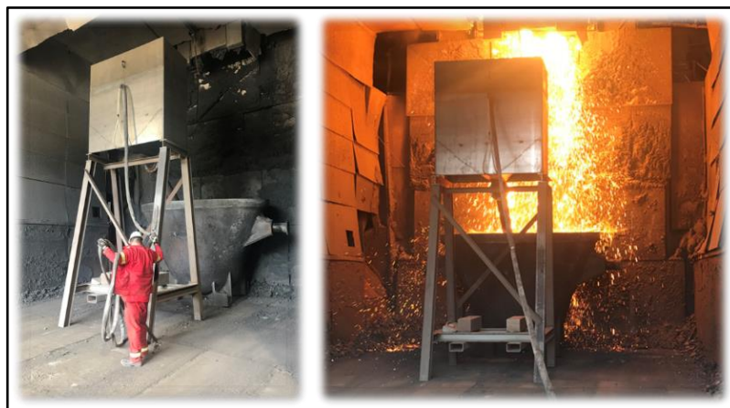
Abbildung 47: Versuchsaufbau zur Optimierung der Fördertechnik: Verkürzung der Anlaufzeit durch Einsatz eines Schneckenförderers.
