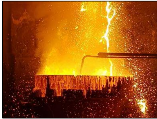
Abbildung 40: Übersäumen der Schlacke während des Einblasens des Reduktionsmittels.
