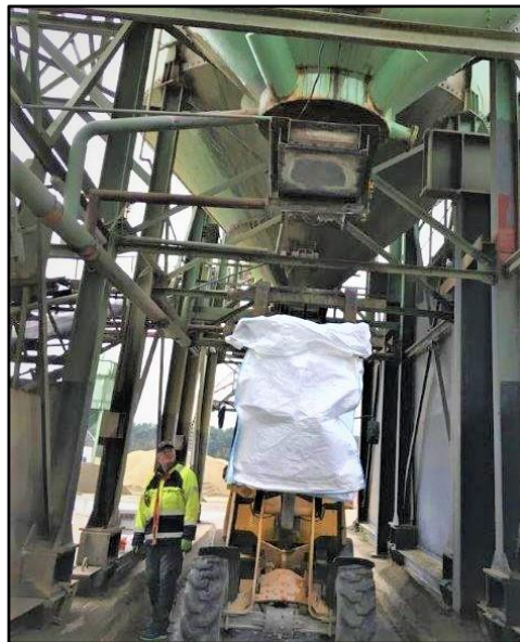
Abbildung 12: Abfüllung der aufbereiteten Schlacke in Bigbags für den weiteren Transport.
