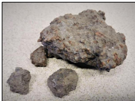
Abbildung 28: Separationseisen der EOS, welches durch die Aufbereitung von der nichtmetallischen Fraktion getrennt wird.
