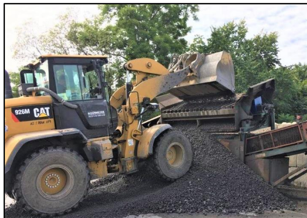
Abbildung 8: Bestückung der Absiebanlage mit EOS der Körnung 0 – 45 mm, um eine Trennung zwischen den Fraktionen 0 – 11 mm und 11 – 45 mm zu erhalten.
