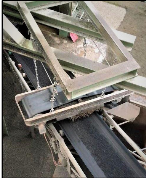
Abbildung 7: Magnetische Trennung der EOS mittels eines Überbandmagneten
