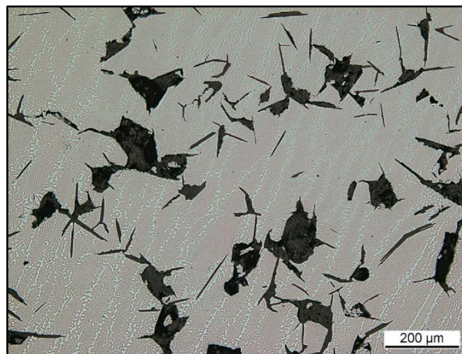
Abbildung 38: Lichtmikroskopische Aufnahme des Regulus des Umschmelzversuchs.
