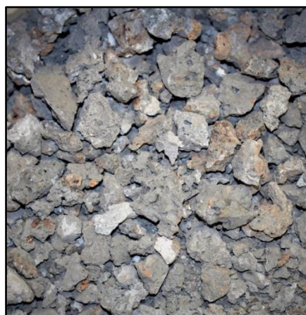
Abbildung 14: Teilprobe BTI71 B1 nach der Teilung mittels eines Riffelteilers.
