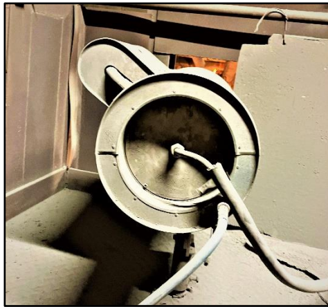
Abbildung 44: Kamera, die durch die Temperatur die austretende Schlacke erkennt und ein Signal zur Förderung des Konditionierungsmittels an die Steuerung der Einblasanlage sendet.
