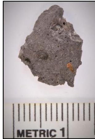
Abbildung 15: Nicht-magnetische Probe nach dem Brechen auf ca. 15 mm, BTI71 B1.
