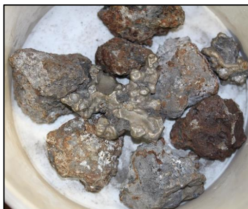
Abbildung 13: Manuell aussortierte Metallteile der Probe BTI 71.
