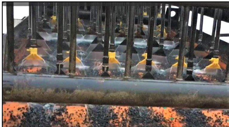
Abbildung 10: Reinigung der EOS mittels Wasserbedüsung, um abschlämbbare Bestandteile von der Körnung zu separieren.
