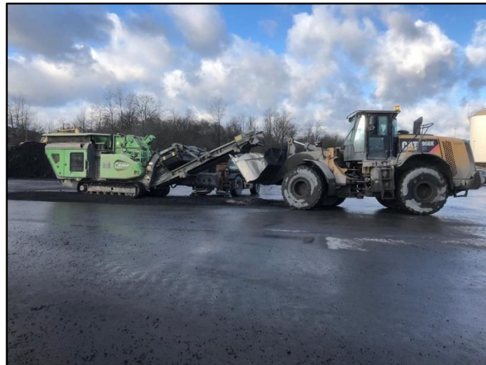
Abbildung 6: Zerkleinerung der Rohschlacke mittels Backenbrecher.
