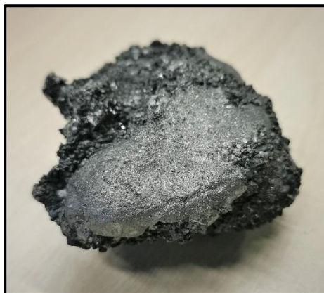
Abbildung 34: Regulus des Umschmelzversuchs von Separationseisen zur Bestimmung des Metallgehalts.
