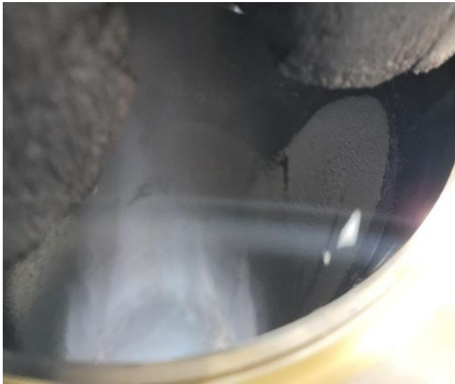
Abbildung 55: Produktreste im Turm nach Sprühversuch am 02.08.2022, Blick von oben in den Turm
