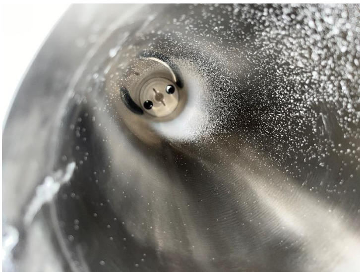
Abbildung 83: Blick in den Einsprühturm nach Entnahme des Siebs nach Ende des Trocknungsprozesses vom 20. / 21.10.2022. Es ist deutlich ersichtlich, dass ein Teil des Produkts an der Wandung des Turms gefroren und dort getrocknet ist.
