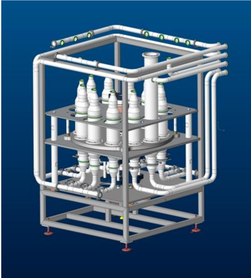
Abbildung 73: Hauptmodul mit Drehteller für 12 Produktträger
