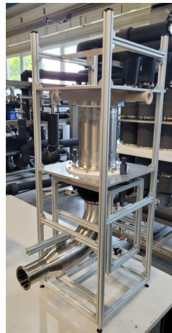
Abbildung 72: Ausführung des Trocknungsturms mit Halterung für die IR-Kamera
