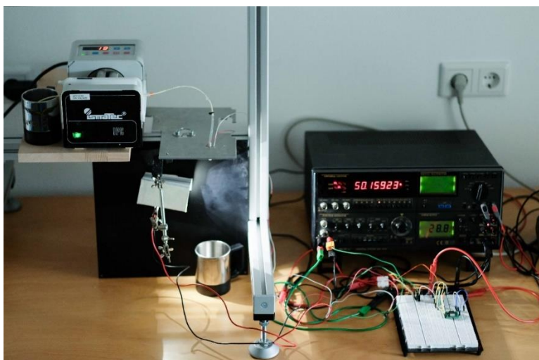
Abbildung 43: Erster Laboraufbau, rechts: Hochfrequenzgenerator als Breadboard-Aufbau, links das LED Stroboskop
