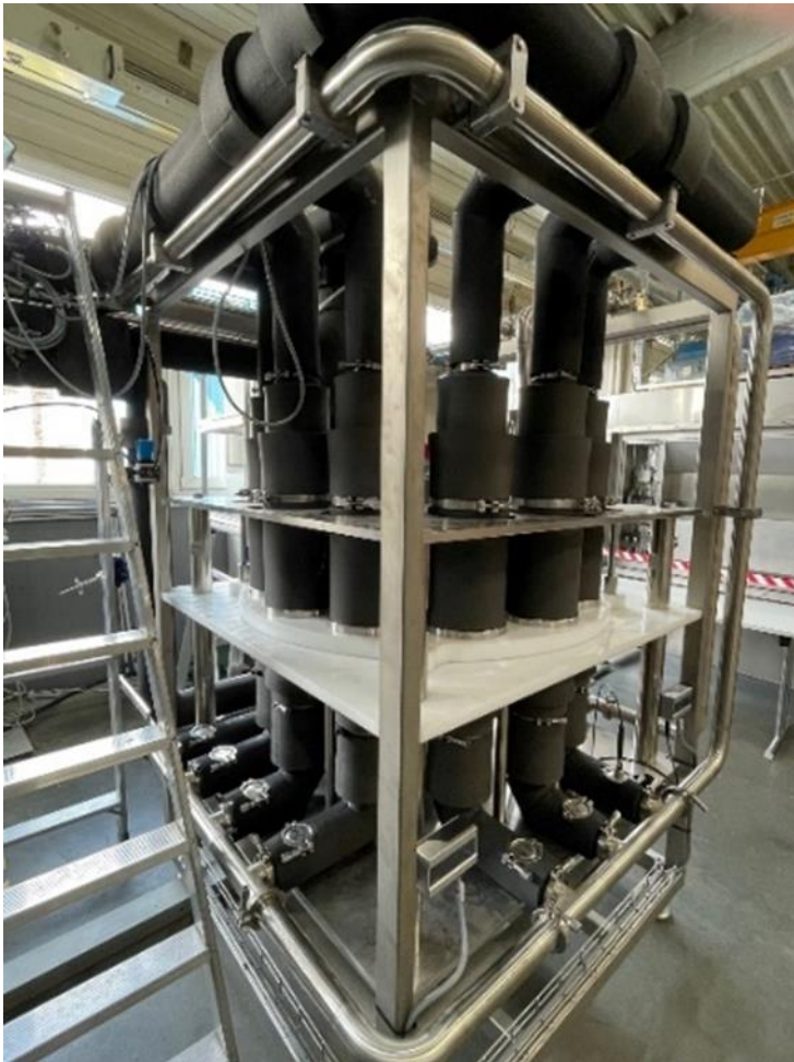
Abbildung 75: Die Anlage inklusive der Isolation der sieben Haupttrocknungs-Stationen
