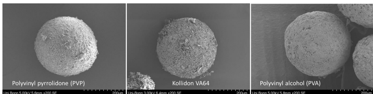
Abbildung 14: Rasterelektronenmikroskop Aufnahmen von der DMSO-basierten SFD-Mikrosphären von Rivaroxaban und entsprechenden Polymer im Verhältnis von 1:4 (Rivaroxaban:Polymer)
