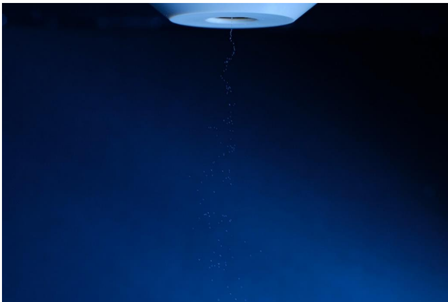
Abbildung 38: Tropfenstrahl unter Einwirkung der Gasströmung
