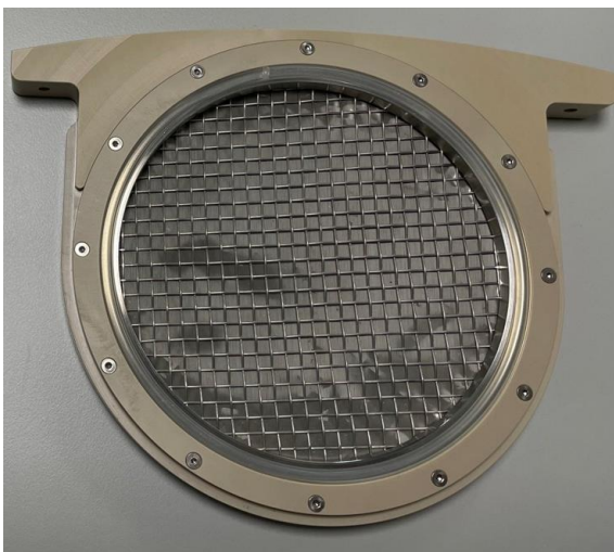
Abbildung 81: Siebträger mit Fassung aus PEEK und hohlen und weichen Silikon O-Ring
