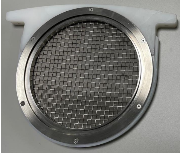
Abbildung 80: Siebträger mit Fassung aus POM
