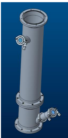
Abbildung 84: Neuer Einfrierturm mit Schaugläsern
