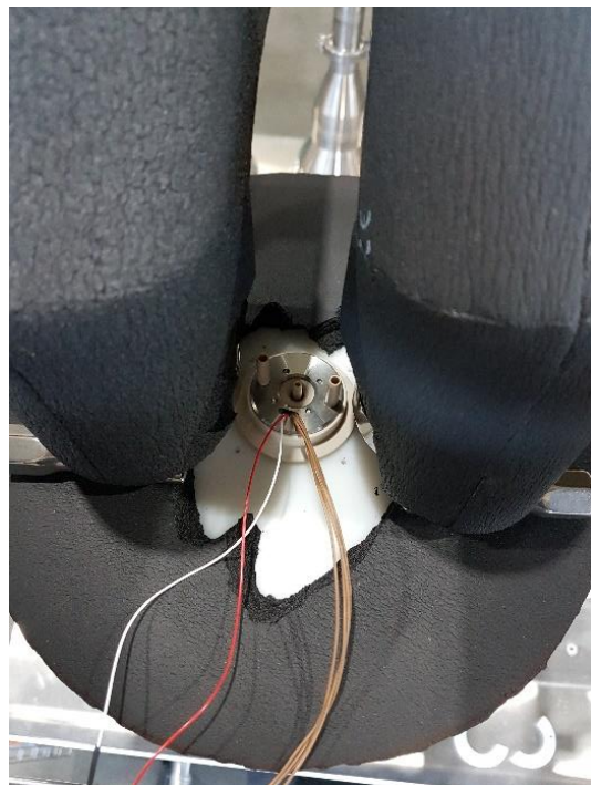
Abbildung 52: Platzierung des Sprühkopfs auf dem Einfrierturm
