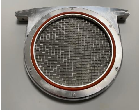
Abbildung 77: Siebträger mit Stahlfassung
