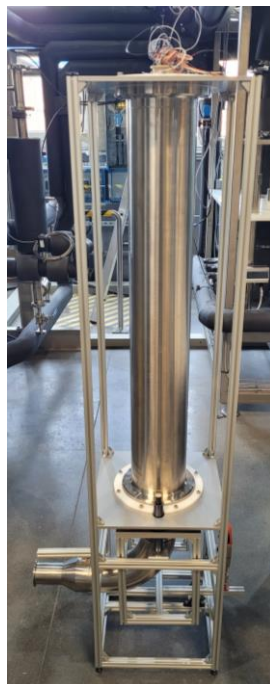
Abbildung 71: Ausführung des Einfrierturms
