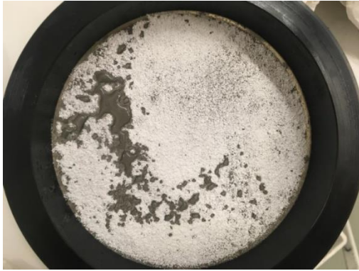
Abbildung 13: Das DMSO-basierte Gut nach 24 Stunden Gefriertrocknung bei -3^{\circ}\text{C} mit flüssigen Anteilen in Bereichen mit Produkt in dickeren Partikelschichten (nach Schmelzen)
