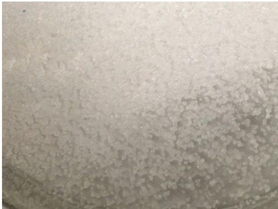
Abbildung 12: Kein Einfrieren der Tröpfchen der DMSO-Lösung beim Sprühen bei -50°C
