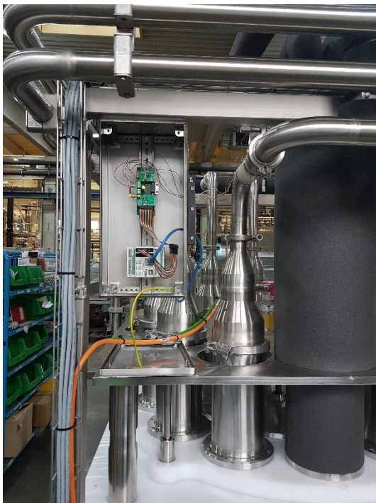
Abbildung 51: Klemmkasten der Elektronik des Tropfengenerators neben schwarz isoliertem Einfrierturm
