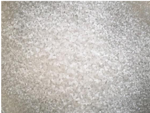
Abbildung 6: Bei -15^{\circ}\text{C} Sprühtemperatur entstehen bei tert-Butanol-basierten Sprühlösungen keine individuelle Partikel, sondern teilweise zusammengeschmolzene Partikel.
