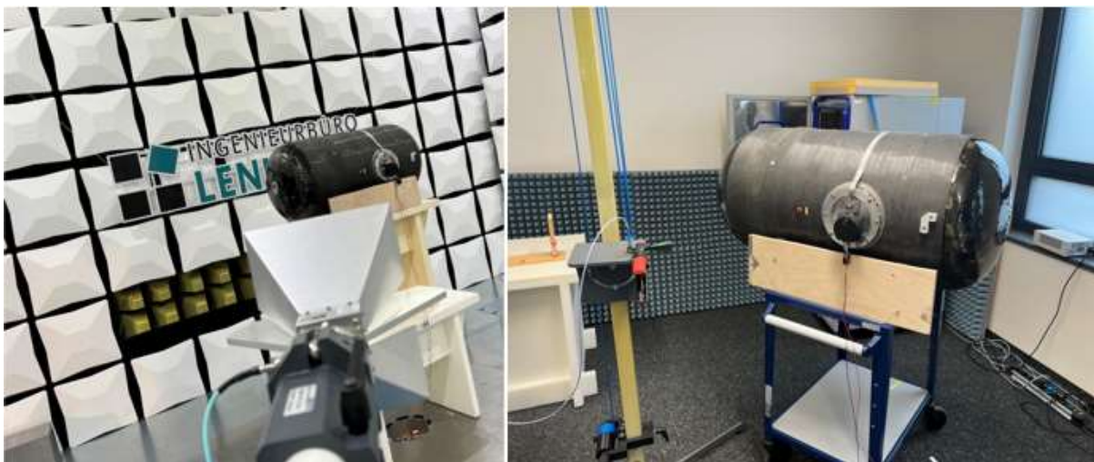
Abbildung 6-47 Prüfaufbau RTCA Messungen unter- und oberhalb von 18GHz
