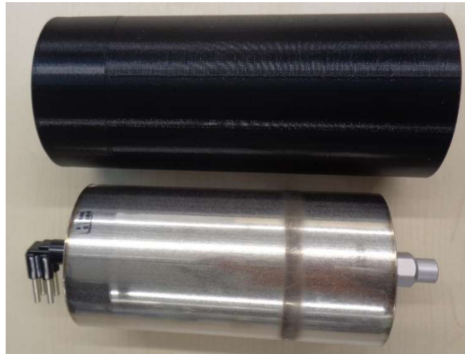
Abbildung 6-89 Kommerzieller Sauerstoffgenerator (AVOX, unten) im Vergleich zu aus der chemischen Entwicklung abgeleiteten Dimensionierung (oben).
