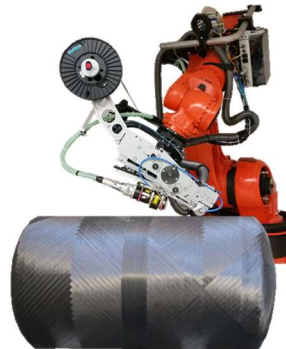
b) Illustration der Faserverstärkung durch thermoplastisches Tapelegen
