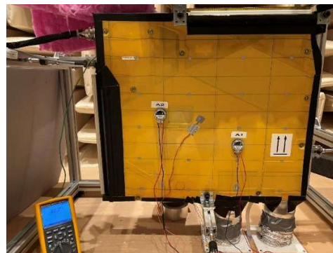
Abbildung 6-80 ARU der DAG mit Aktuatoren zur aktiven Geräuschreduktion (Foto DLR)
