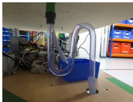
Abbildung 6-70 Siphon-Konzept bei Nachtest
