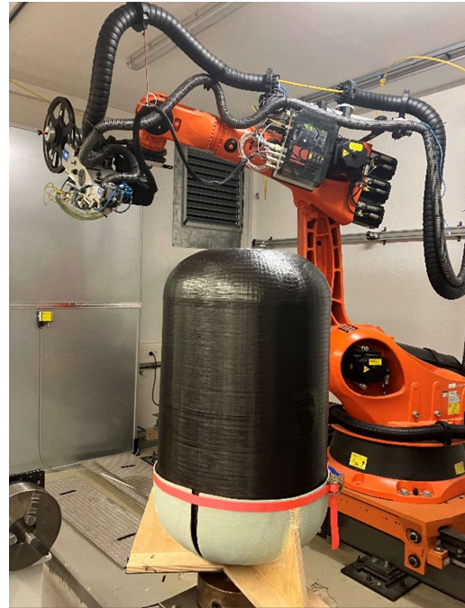
(b) Tank nach Abschluss des Legeprozesses
