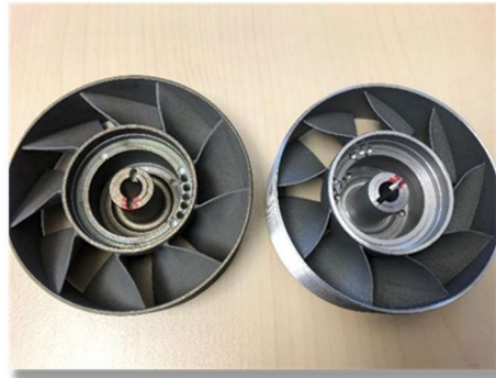
Abbildung 6-22 Gedrucktes Lüfterlaufrad mit optimierter Schaufelgeometrie für ARU
