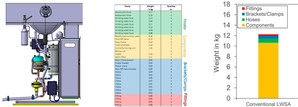
Abbildung 6-61 Vorgehen zur Ermittlung des Gesamtgewichtes am Beispiel des konventionellen Lavatory-Wassersystems.
