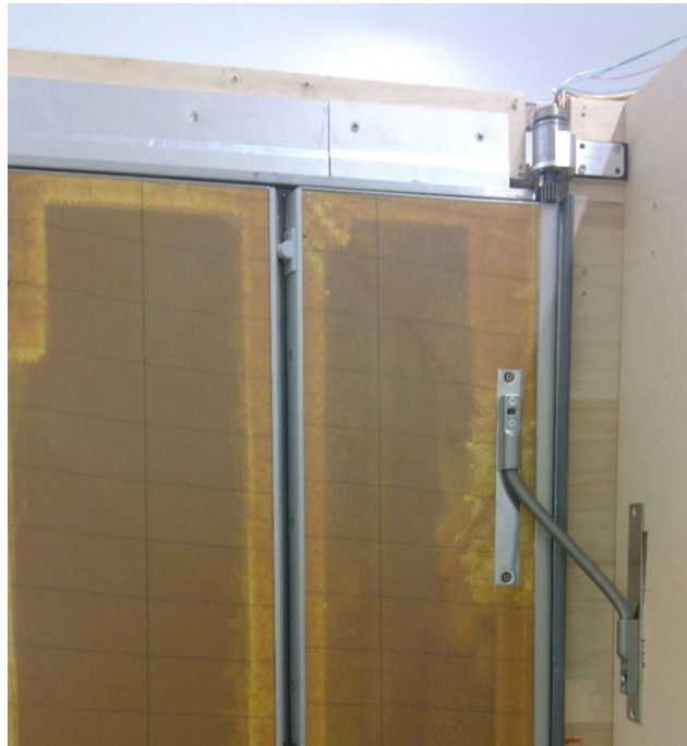
Abbildung 6-30 Tür mit Motor und Kabelverbindung
