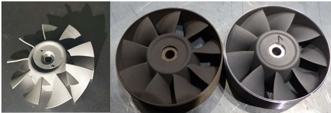
Abbildung 6-76 Aeroakustisch optimierte Laufradgeometrien (Mitte u. rechts) im Vergleich zur Ausgangsgeometrie (links)
