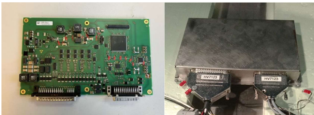
Abbildung 6-29 Steuerelektronik MMCU und Gehäuse
