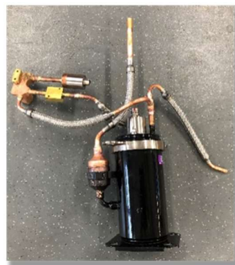
Abbildung 6-75 Modifizierter Kompressor mit Metallschläuchen
