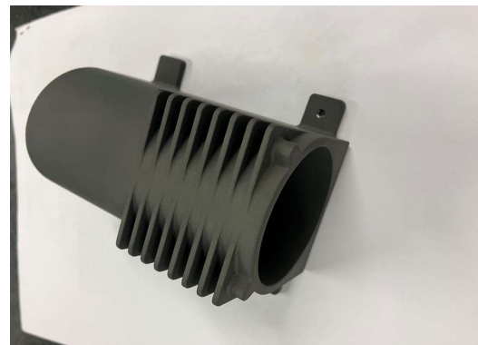
Abbildung 6-23 3D-gedrucktes und integrales Pumpengehäuse
