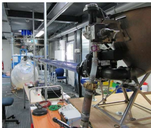
Abbildung 6-11 Teststand für Versuche zur Rohrverstopfungserkennung
