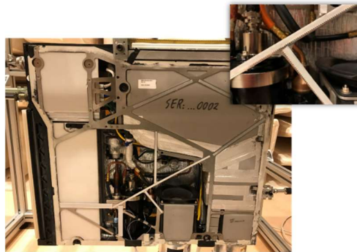
Abbildung 6-79 ARU der DAG mit CLD als passive Geräuschreduktionsmaßnahme (Foto: DLR)
