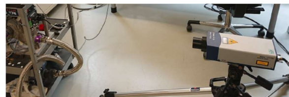
Abbildung 6-6 Messungen mit Laservibrometer
