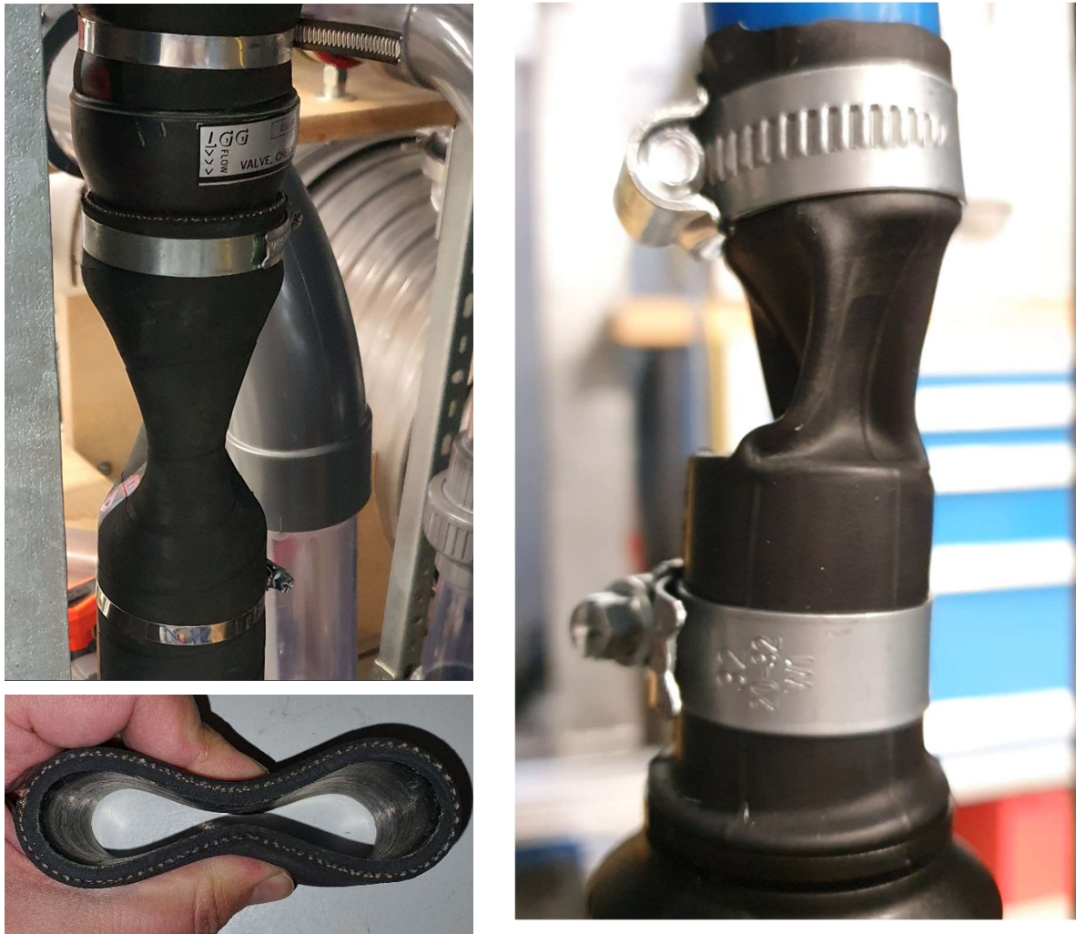
Abbildung 6-57 Links: Quetschventil aus gewebeverstärkter Schlauchtülle inkl. Detailansicht Querschnitt; rechts: Quetschventil aus Fahrradschlauch
