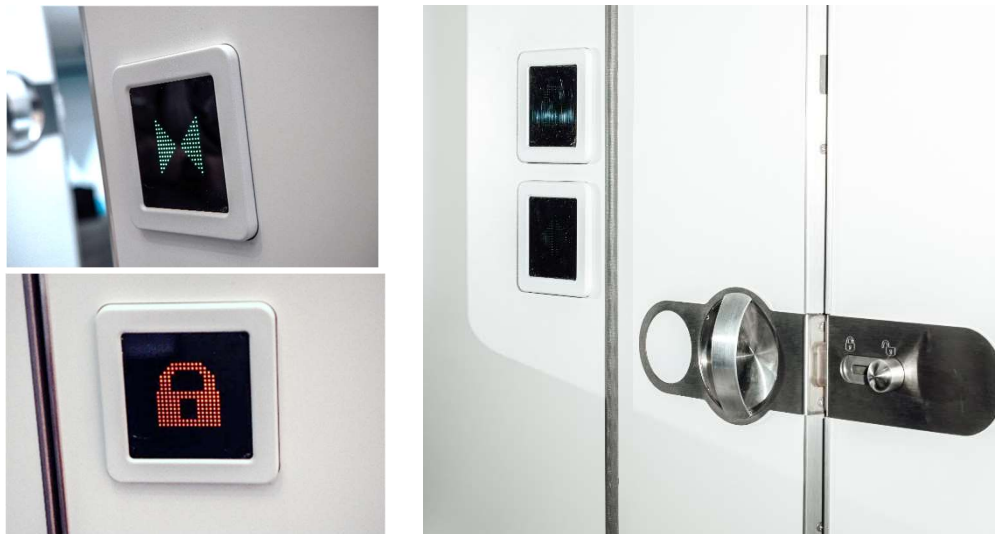
Abbildung 6-35 Messedemonstrator Details: berührungslose Taster und Schloss
