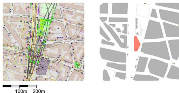
Abbildung 3: Münchner Freiheit (Basisszenario). Die Topografie wurde aus OpenStreetMap 1 (links) in den Personenstromsimulator Vadere (rechts) überführt.
