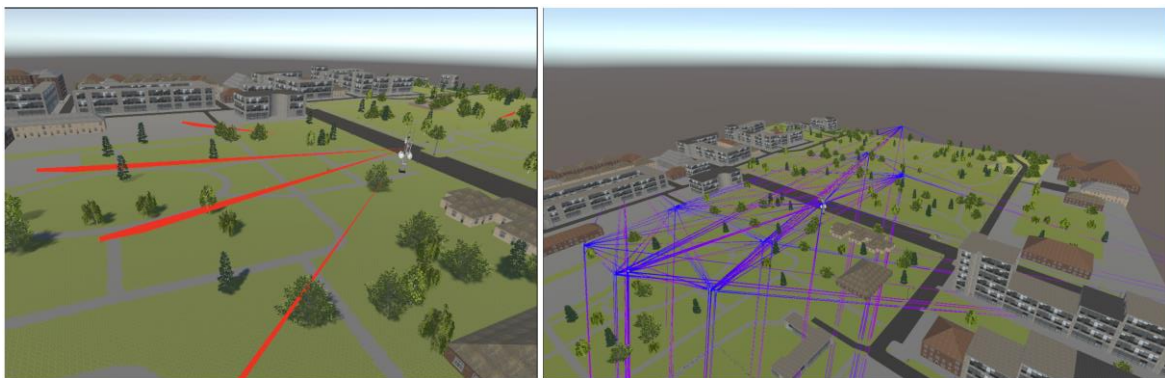
Abbildung 27: Beispiele für eine 3D-Visualisierung des Aussendens von Informationen über die Basisstation (links) sowie mehrerer direkter und zellulärer Kommunikationsverbindungen (rechts).
