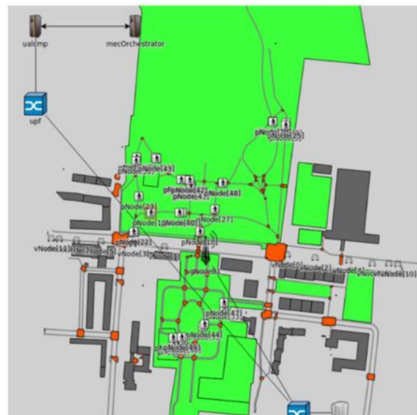
Abbildung 12: Multi-modales Verkehrsszenario mit Fußgängern und Fahrzeugen dargestellt im roVer Simulationsframework CrowNet.
