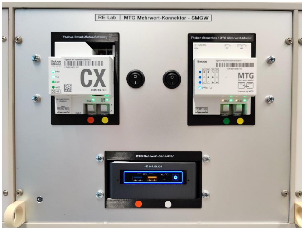
Abbildung 46: Sichere, BSI-konforme Kommunikation mit Mehrwert-Konnektor (unten), SMGW (links) und Steuerbox/Mehrwert-Modul (rechts)
