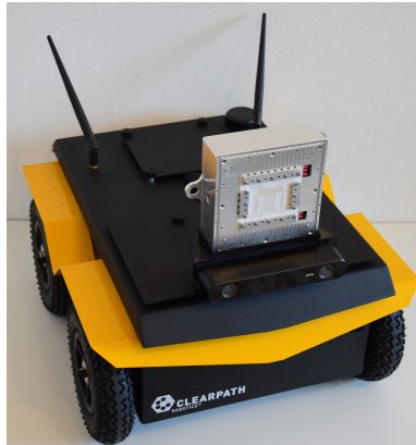
Abbildung 6 Die mobile Roboterplattform der TUM, ausgestattet mit Stereokamera & Radarsensor (Infineon AG).
