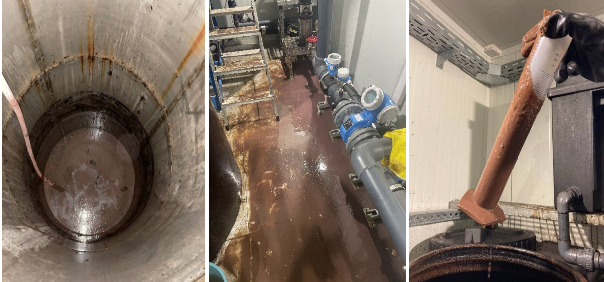
Abbildung 8: (a) Das Sediment im Vorlagetank hatte dreifach höhere oTS-Konzentrationen als die OMW-Mischprobe, (b) Entlüftungsprobleme bei der Feedpumpe der CMF führen zu einer Überschwemmung mit Olivenmühlenabwasser in der Pilotanlage, (c) das Retentat der Membranfiltration erhält die Viskosität von warmer Schokolade
