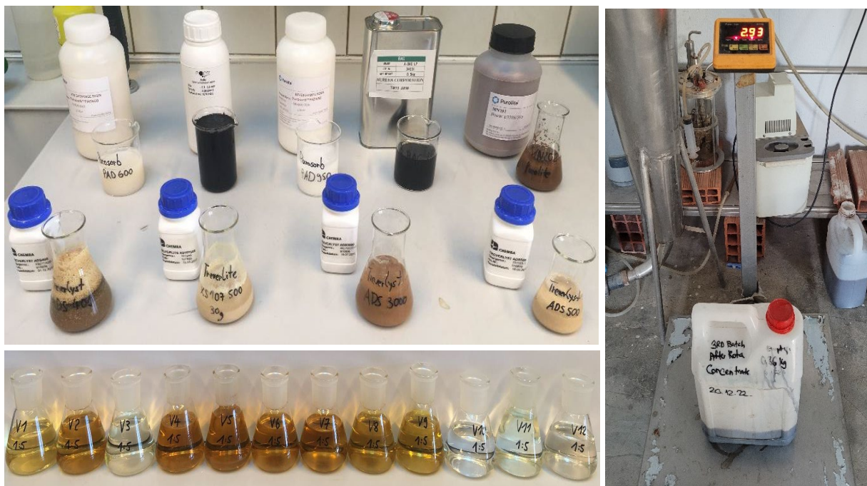
Abbildung 7: (a) für das Screening vorbereitete Adsorptionsmittel; (b) beispielhafte Desorbate-Reihe eines Versuches; (c) auswiegen eines Konzentrates nach der Aufkonzentrierung im Rotationsverdampfer
