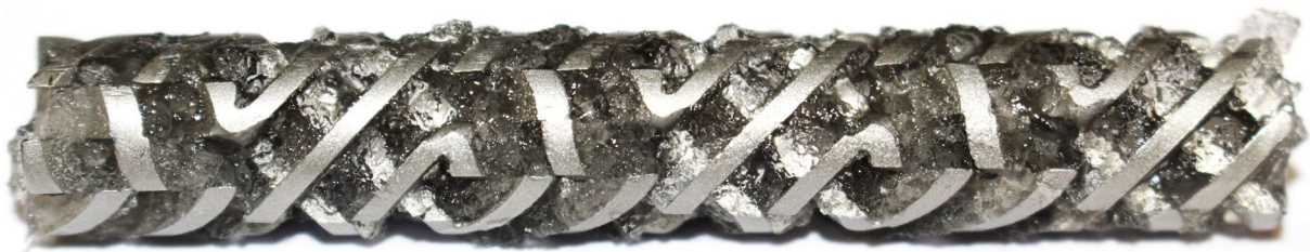
Abb. 9: Statisches Mischelement nach 8 h Betriebsdauer bei Standardbedingungen.
