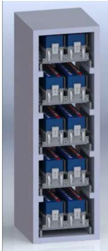
Abbildung 6: Skizzierter Batterieschrank mit 10 Batteriemodulen
