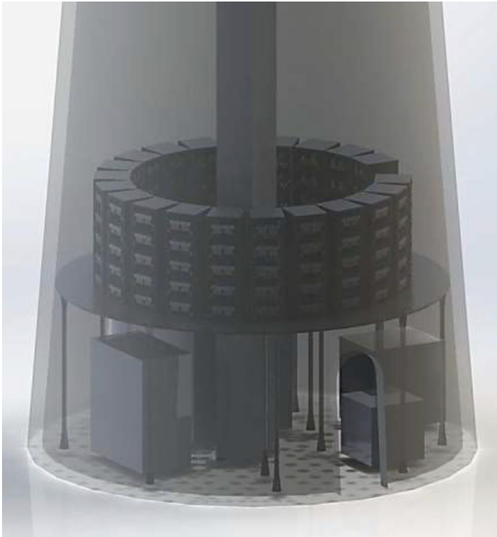
Abbildung 5: Anordnung des Batteriesystem (oben) und des Umrichters (unten) im Turmfuß einer Windkraftanlage
