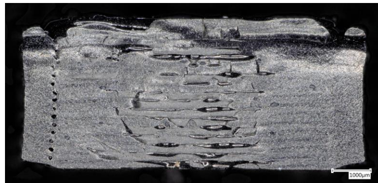
Abbildung 2.2.4.10: Mikroskopie typischer Defekte durch additive Fertigung im FFF-3D-Druckverfahren bei einer 90°-Probe
