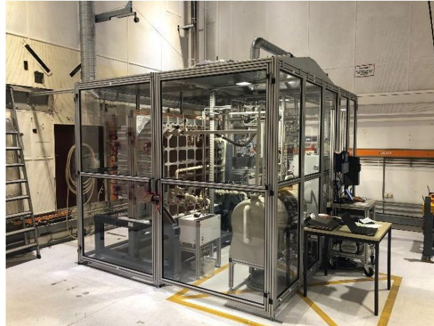
Abbildung 11: Teststand mit Elektrolysezelle C5000.
