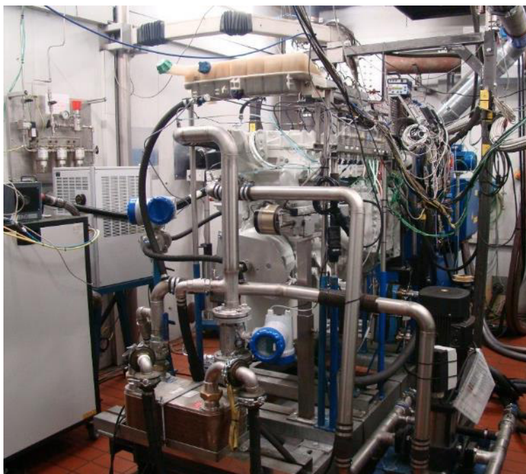
Abbildung 1: Aufbau des Versuchsmotors im Vollmotorenprüfstand
