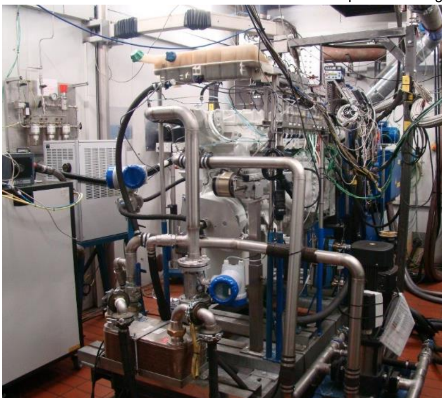
Abbildung 3: Aufbau des Versuchsmotors im Vollmotorenprüfstand
