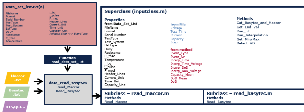
Abbildung 10: Darstellung des entwickelten Datenformats ("Inputclass.m") inklusive Datenflüsse ausgehend von Rohdaten ("Maccor.txt, Basytec.txt & „BTS“/"QSI") sowie Metadateninputfile („Data_Set_list.txt“).
