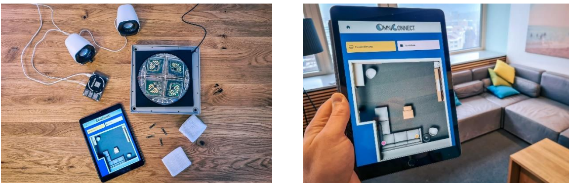
Abbildung 13: Prototyp bestehend aus der Lampe, den Tags und der Sprachsteuerung sowie der grafischen Benutzeroberfläche
