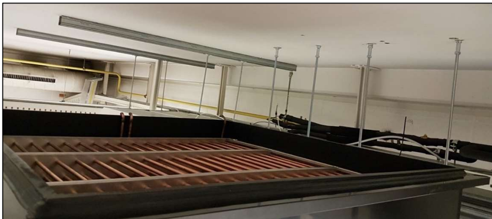
Abb.116: Versuchswärmeübertrager mit Behälter vor dem Befüllen
