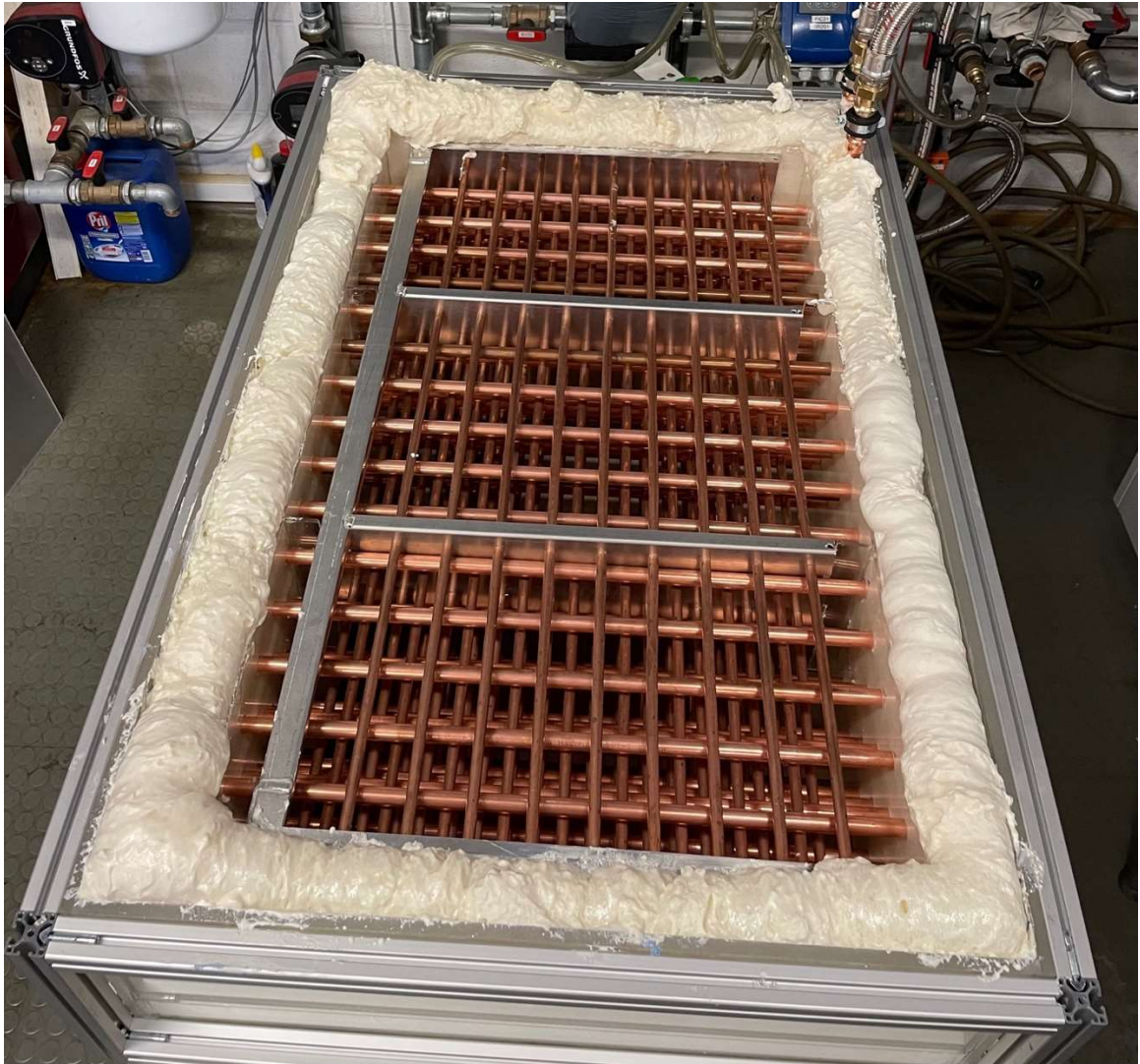
Abb.123: Kreuzstromwärmeübertrager im 3-Medien-Latentkältespeicher
