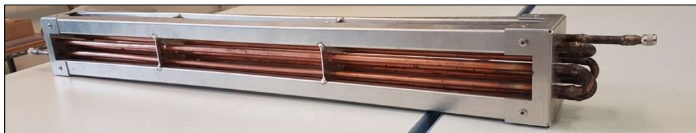
Abb.114: Wärmeübertrager zu Voruntersuchungen
