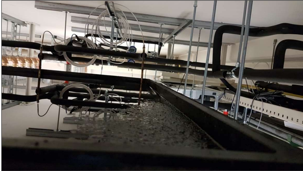
Abb.117: Versuchswärmeübertrager mit Behälter nach dem Befüllen und kältetechnischem Anschluss
