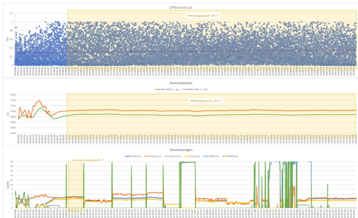
Abbildung 4.2.3-1: Differenzdruck, Gastemperaturen und Gaszusammensetzung an der Messstelle 1 bei der Teilbeladung des Versuchsofens
