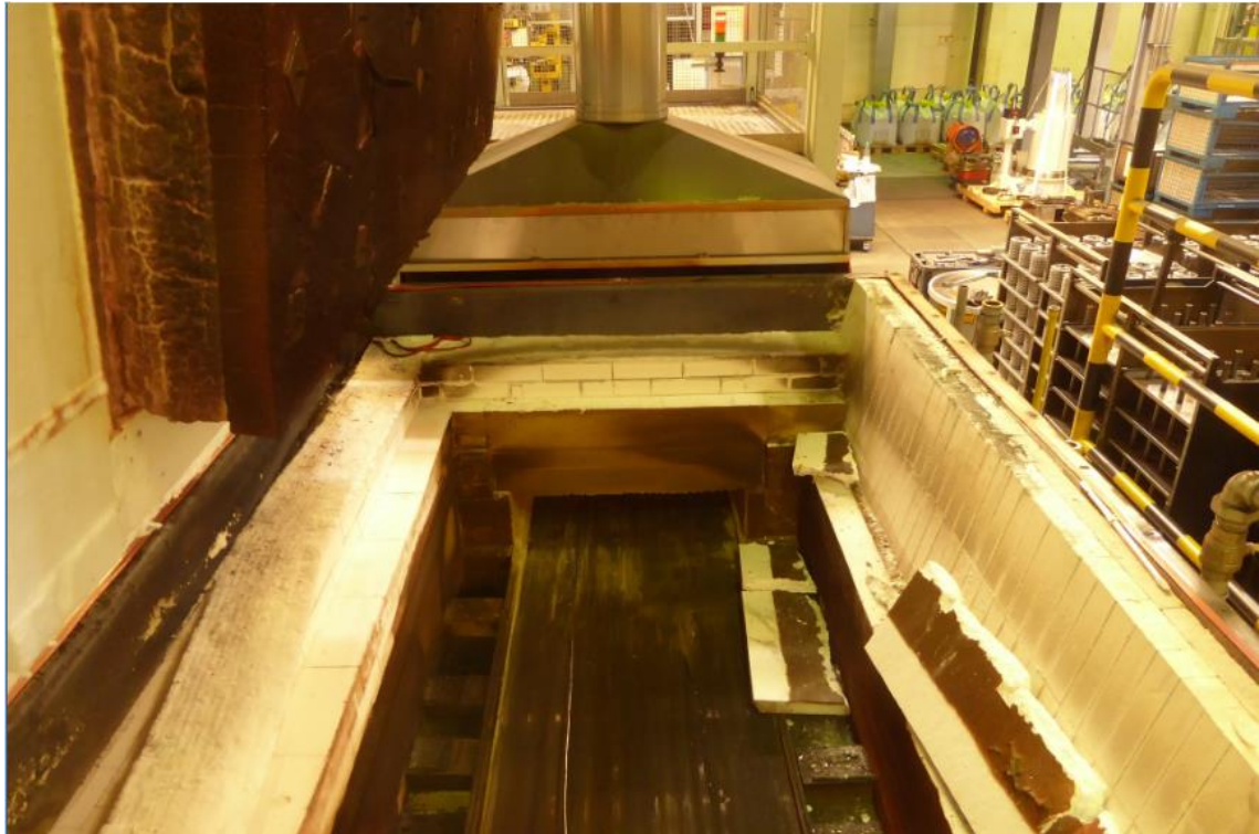
Abbildung 4.2.2-3: Blick nach vorne in die Ausbrennzone von Ofen BBR 212
