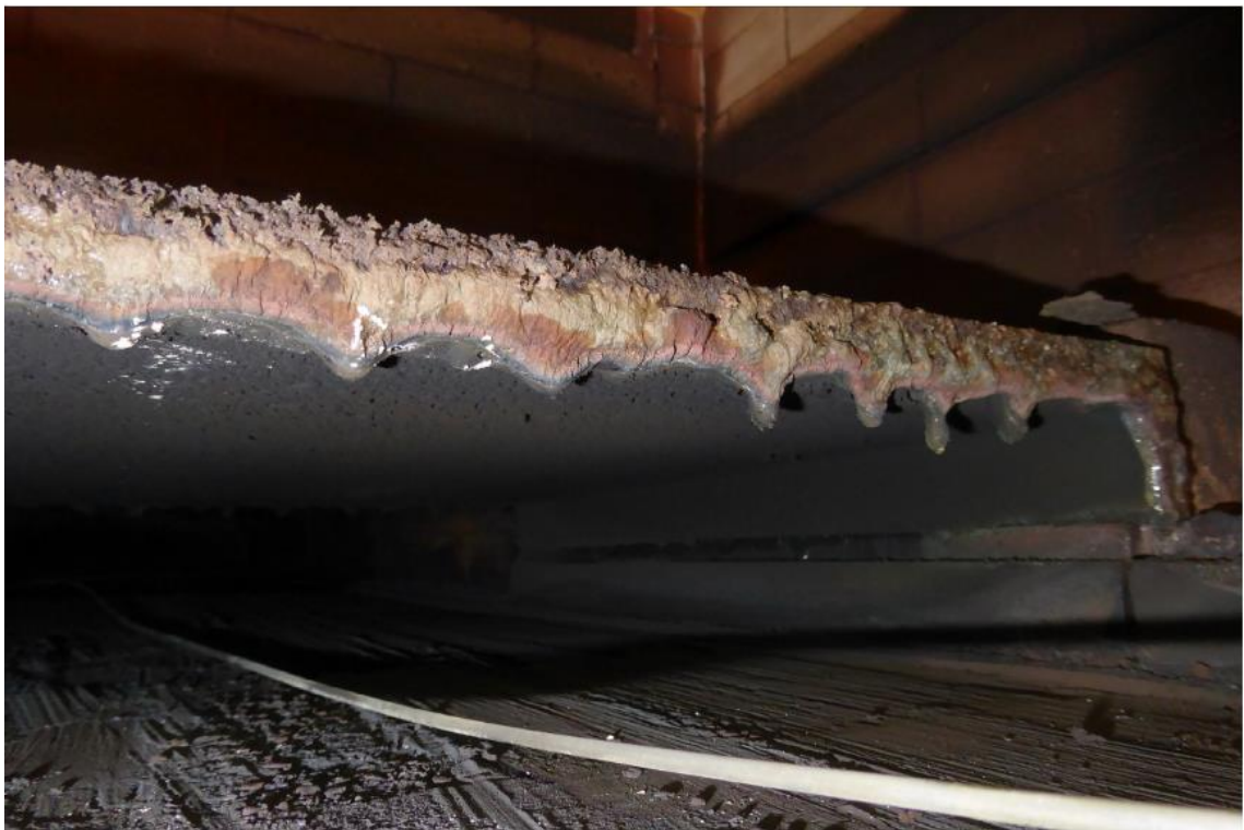
Abbildung 4.2.2-4: Schacht zur Sinterzone von BBR 212 (Deckel leicht angehoben, glasartige Ausschwitzungen hängen stalaktitartig herab)
