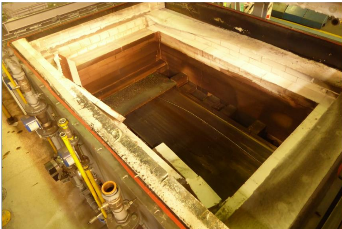
Abbildung 4.2.2-2: Blick in die Ausbrennzone und auf den Schacht zur Sinterzone von Ofen BBR 212
