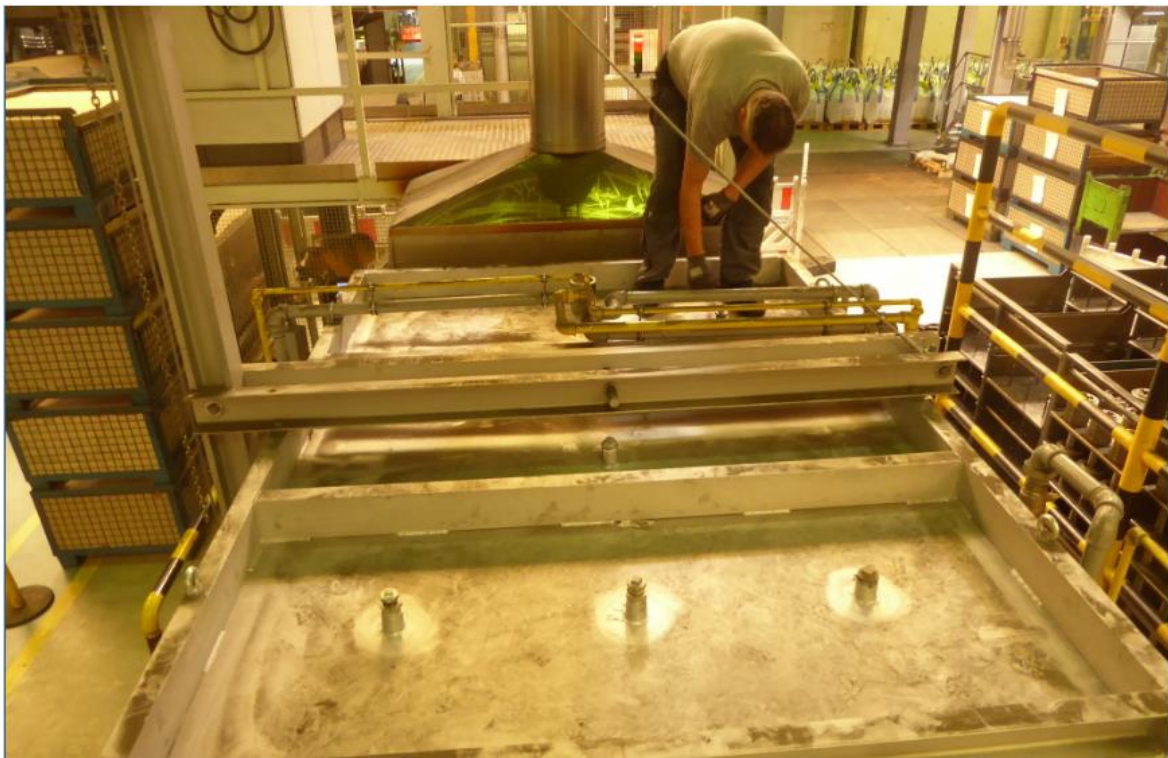
Abbildung 4.2.2-6: Im Vordergrund die neuen Flansche für die Zugänge der Messsensoren im Ofendeckel von BBR 212
