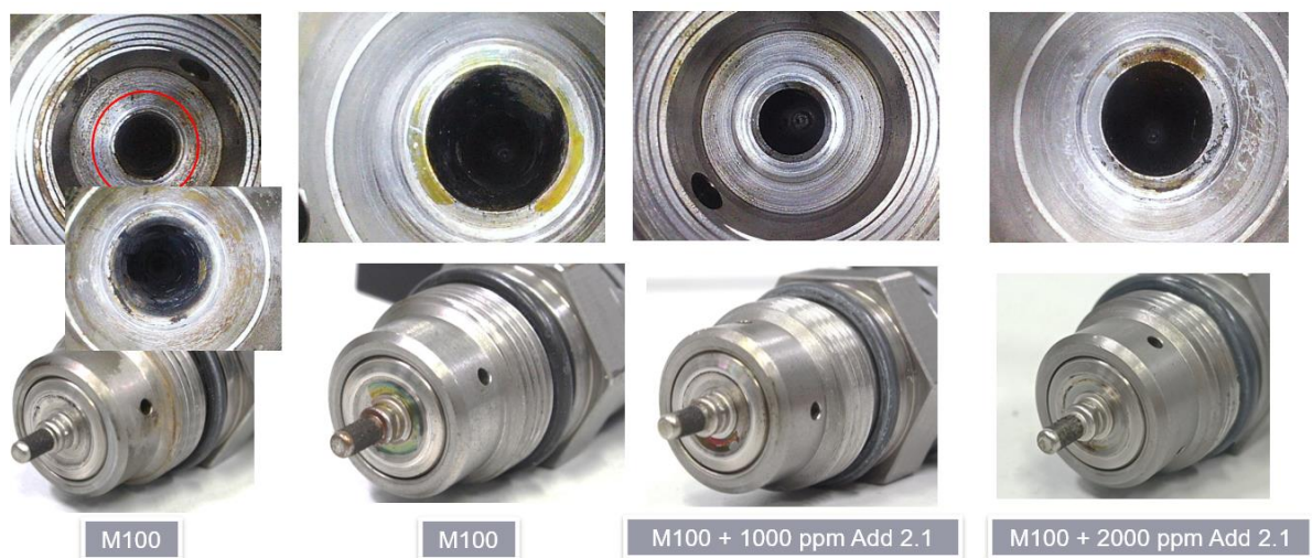
Abbildung 4: Von links nach rechts zeigte sich der Einfluss von Additiven am Druckregelventil. Mit M100 (Links) wurde eine leichte Korrosion und Materialabrieb beobachtet. Die Verbesserungen durch die Additive sind auf den rechten Bildern sichtbar
