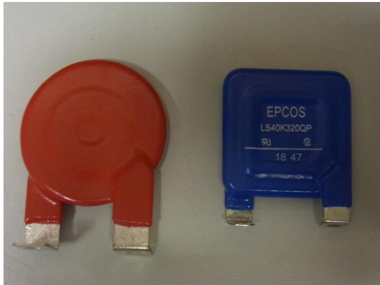
Abbildung 2.88: Bauform der verwendeten Varistoren (Littlefuse => rote Varistoren, Epcos => blaue Varistoren)
