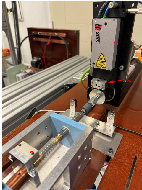
Abbildung 2.7: Laserinterferometrisches Wegmesssystem bestehend aus: 1 Sensorkopf, 2: Umlenkspiegel, 3: Reflektor
