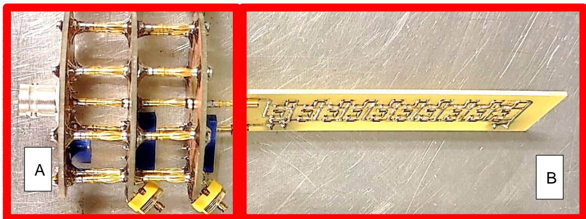
Abbildung 2-138 Ein Spannungsteiler ohne Gehäuse. (A) Niederspannungsteil. (B) Hochspannungsteil
