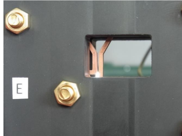
Abbildung 2.16: Lichtbogen in der Modellfunkenstrecke.
