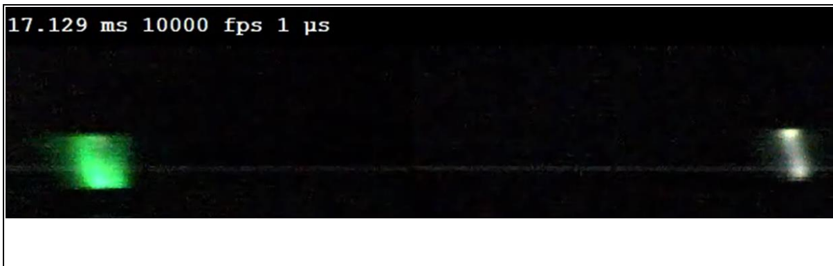
Abbildung 2.40: Kameraaufnahme eines 50 A Bogens zwischen den Kontakten des HVRs durch die optischen Zugänge nach Abbildung 1b). Belichtungszeit 1 \mu s, Abtastrate 10 000 fps. Hierbei weisen die Farbunterschiede auf die Zusammensetzung des Plasmas hin.
