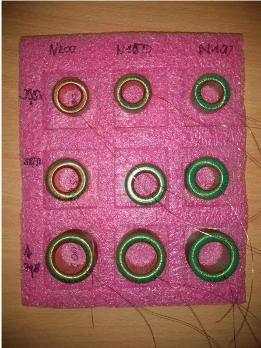
Abbildung 67: Ringkerndrossel EI 190 601 11 99 für die Erkennung des Stromnulldurchgangs
