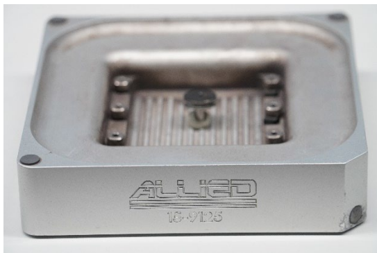
Abb. 2.1.12: Fixierplatte des Trägers an die Allied Mikrofräse (Bild links) und exakter Wiedereinbau des Stiftprobentellers in den Träger (Bild rechts)
