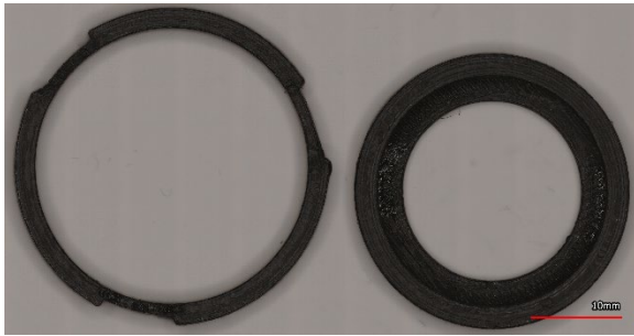
Abb. 2.1.4: Halte- und Fixierring mit 3 Fixiermarken, von oben (links) und von unten (rechts).
