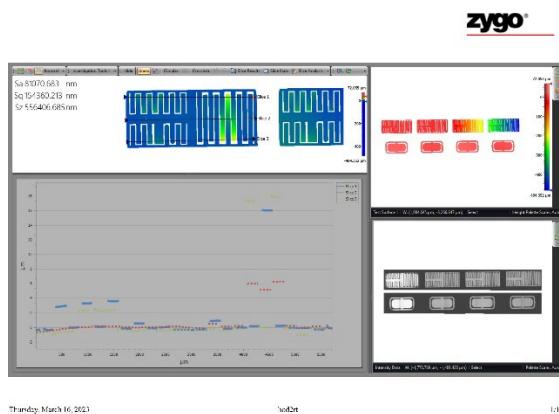
Abb. 4.4.4.: WLI-Messungen im eigenen Labor an Testproben bei 25°C Raumtemperatur (Bild links) und bei 65°C mit dem Heiz-Kühl Tisch (Bild rechts).
