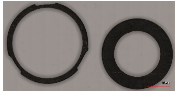
Abb. 2.1.4: Halte- und Fixierring mit 3 Fixiermarken, von oben (links) und von unten (rechts).
