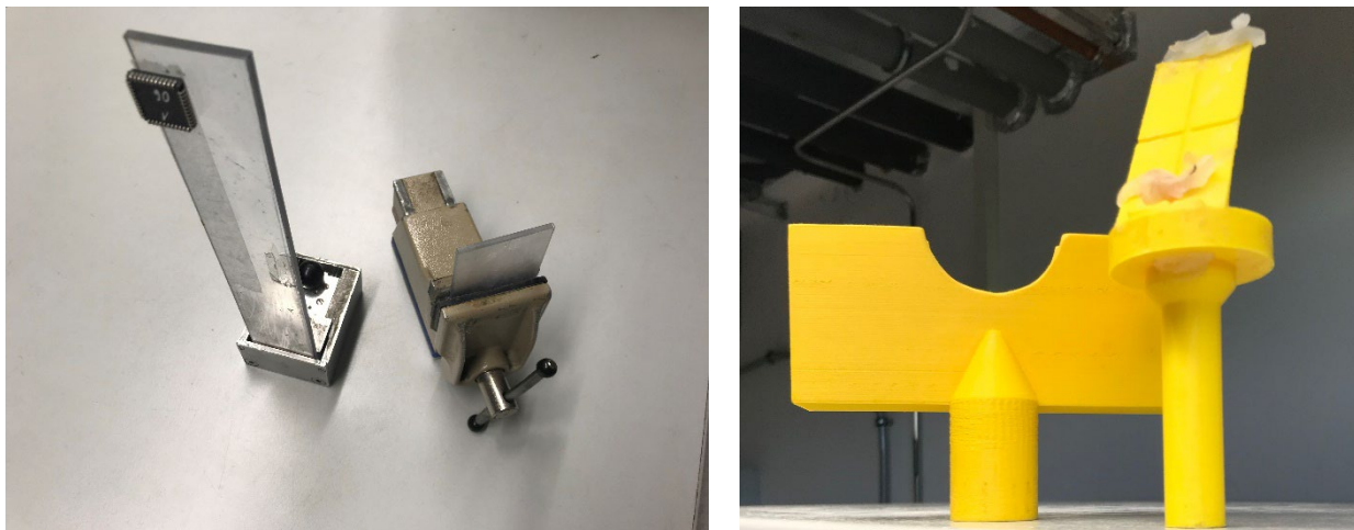
Abb. 2.1.1: Diverse Fixierungsmöglichkeiten für die 2D-Röntgenanlage (links) und die Röntgentomografie (CT, rechts).
