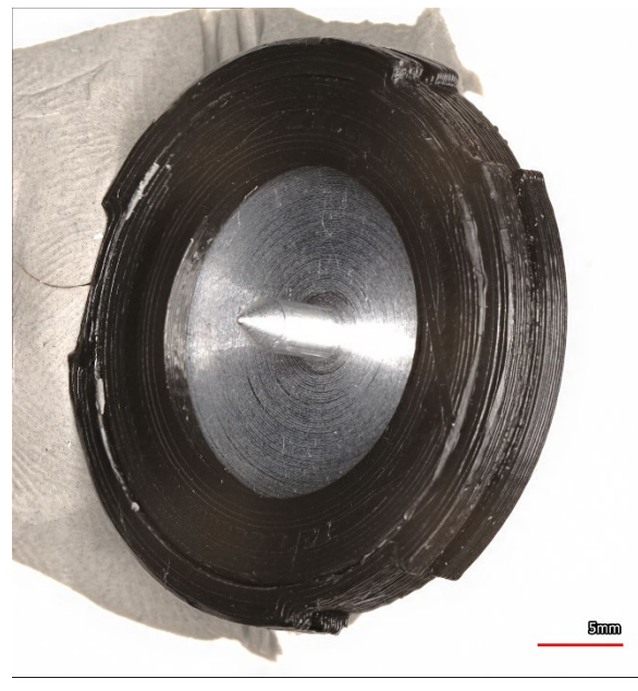
Abb. 2.1.5: Halte- und Fixierring mit Standard REM-Stub, von oben (links) und von unten (rechts).
