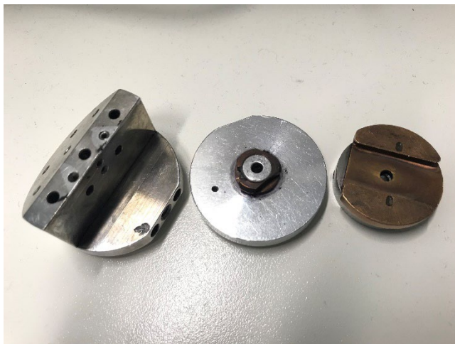
Abb. 2.1.3: Diverse Ausführungen von Probenträgern für REM (Zeiss, links) und FIB (FEI, rechts).
