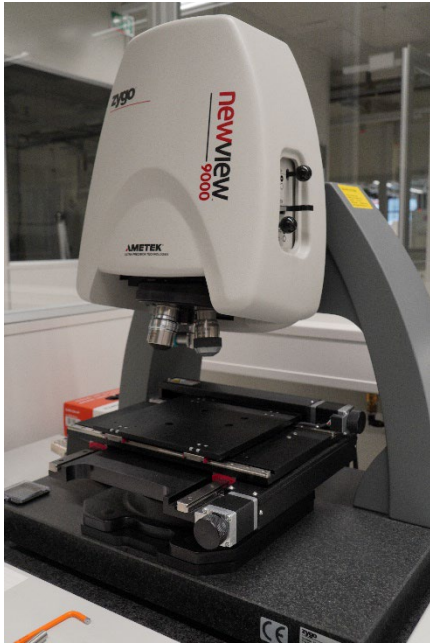
Abb. 4.4.1.: WLI newview 9000 der Firma Zygo (Bild links), Heiz-Kühl Tisch von Dantec Dynamics / Instec (Bild rechts)
