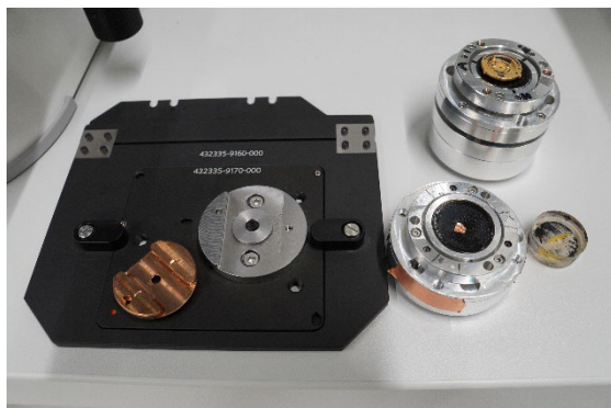
Abb. 2.1.17: Adapterplatte und Probenträger mit und ohne Tiltfunktion (Bild links) und eingebauter Probenträger V0 unter dem Lichtmikroskop (Bild rechts)
