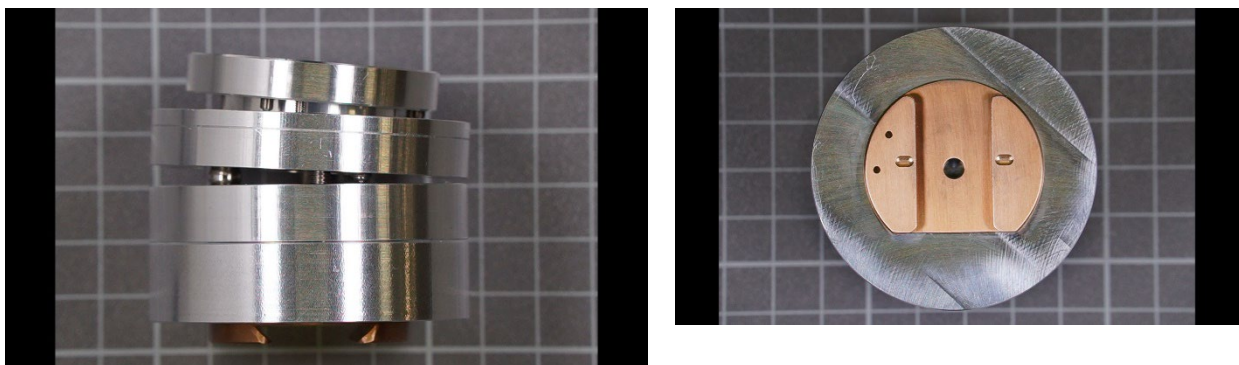
Abb. 2.1.8.: Probenträger mit Kippfunktion, Ansicht von der Seite (Bild links), Anschluss für die Adapterplatte für Zeiss Mikroskope (Bild rechts).
