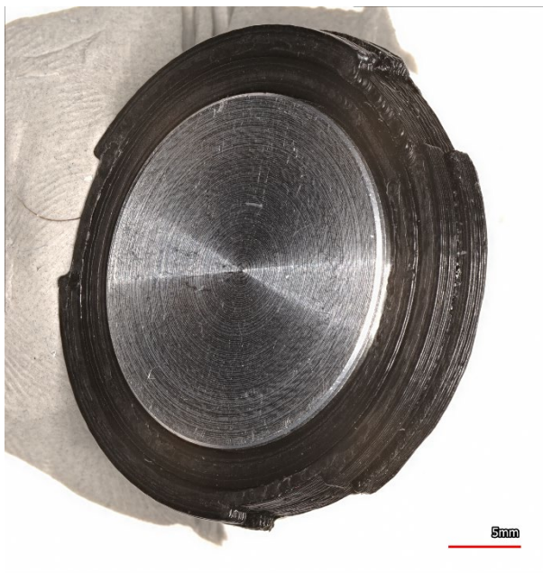
Abb. 2.1.5: Halte- und Fixierring mit Standard REM-Stub, von oben (links) und von unten (rechts).
