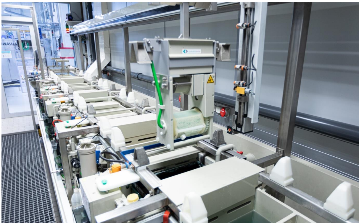
Abbildung 1: Kleingalvanikautomat mit nachgerüsteter Trommel
