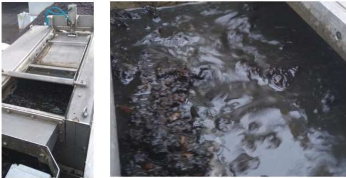
Abbildung 41: Links) Versuchsaufbau für Test im Pilotmaßstab, Rechts) durch Flockungsmittel entstandene Aggregate im ansonsten homogenen Gärrest
