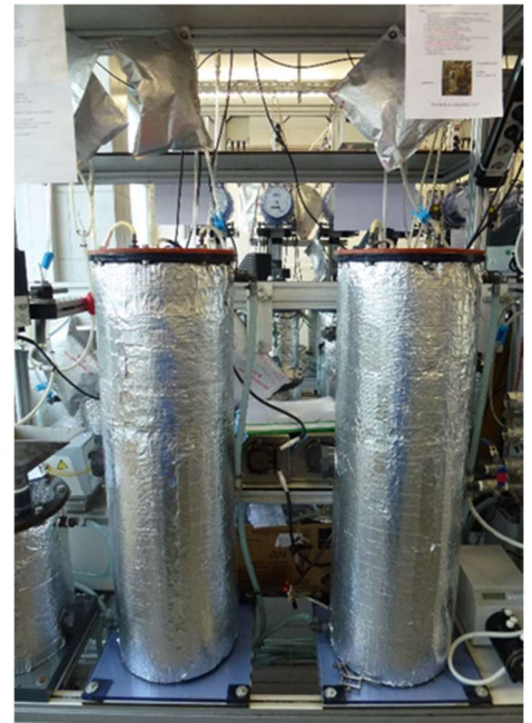
Abbildung 12: A) Schematischer Aufbau eines Trockenfermenters (Stur, DBFZ); B) Versuchsstand mit zwei baugleichen Trockenfermentern
