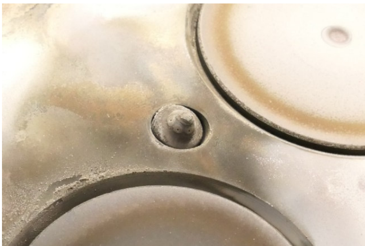
Abb. 15: Injektorspitze ohne Verkokungen bei Befundung nach Dauerlauf
