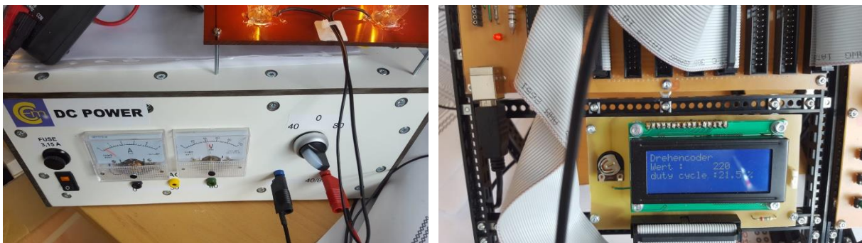
Abbildung 29: Entwickeltes Netzteil (links) und Steuereinheit mit Anzeige einer Winkelstellung des SSR in Abhängigkeit der Bestromungsstärke (rechts)
