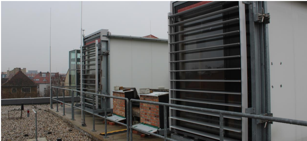
Abbildung 16: An der HTWK Leipzig installierte Verschattungssysteme an Mess-Klimazellen links als Standardvariante mit Linearantrieb und rechts mit Änderungen zur Installation eines FGL-Antriebs
