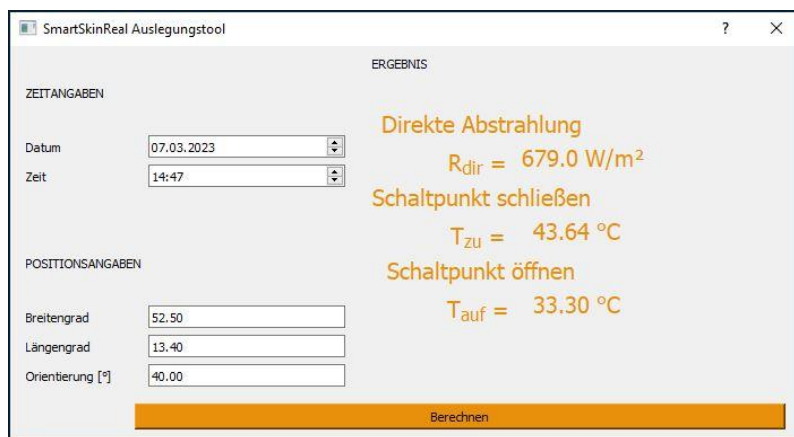
Abbildung 33: Benutzeroberfläche des SmartSkinReal Auslegungstools mit Eingabe von Ort- und Positionswerten und Ausgabe der Schalttemperaturen
