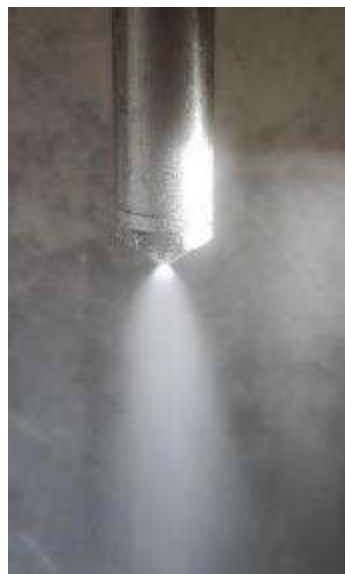
Abbildung 57: 2-Phasen-Düse mit Wasser in einem Sprühversuch vor der Installation im rGO Reaktor
