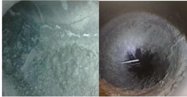
Abbildung 54: Ablagerungen in der Anlage. Links: Rohrleitung vom Reaktor zum Krümmer. Rechts: Reaktorkopf.
