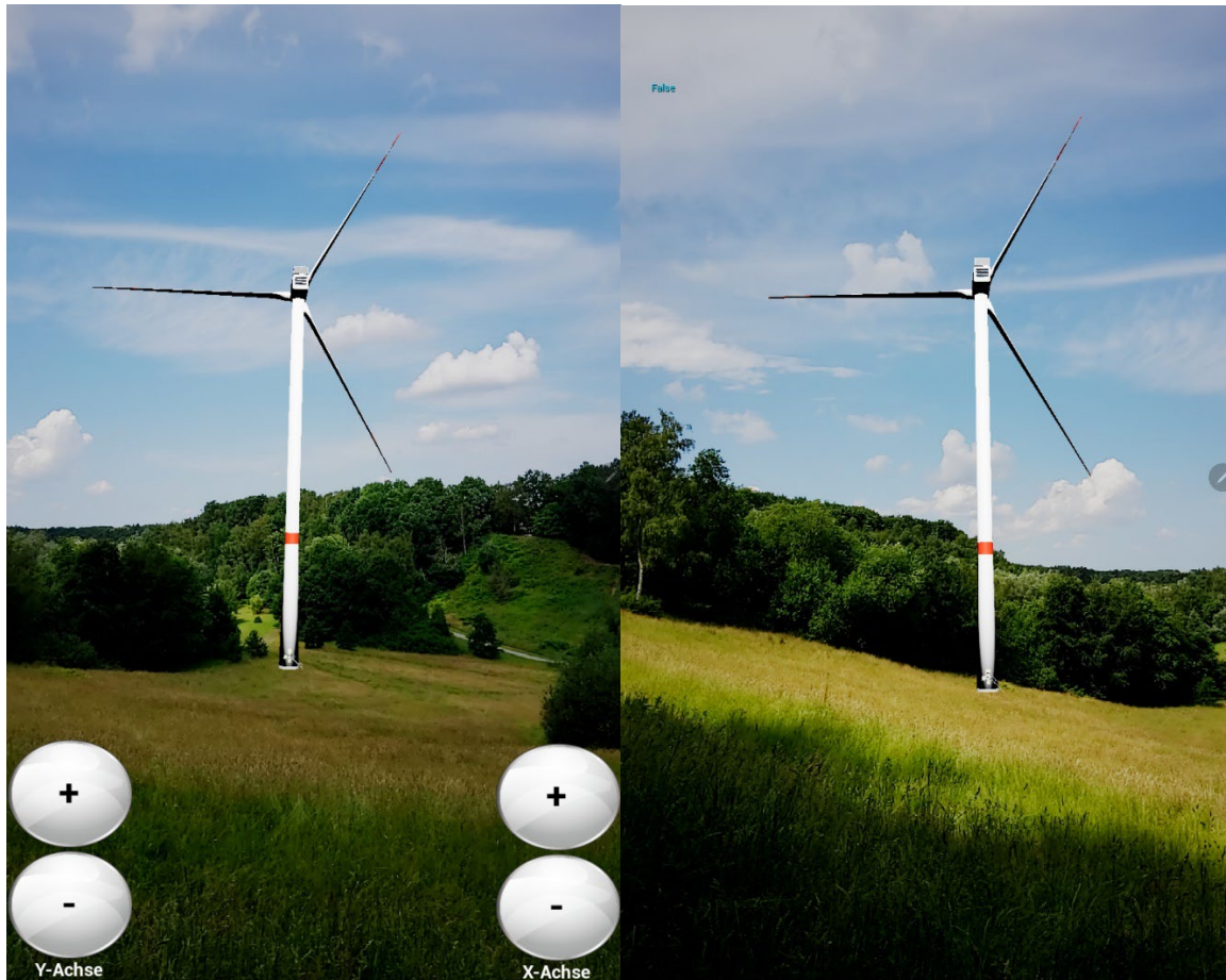
Abbildung 16: Virtuelle WEA als Überlagerung über einem Kamerabild.
